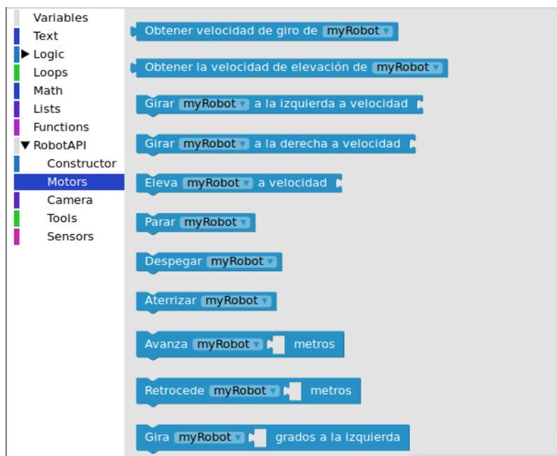
Figura 4.9: Espacio de trabajo de *Scratch* con los bloques del dron incorporados
