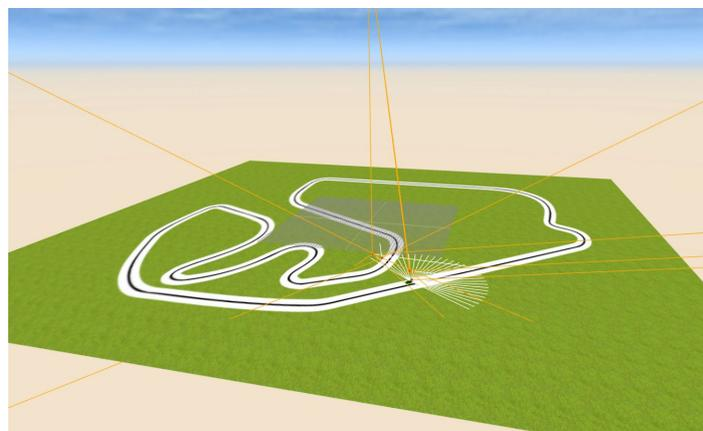
Figura 4.17: Escenario para el ejercicio para el *robot piBot* sigue-líneas infrarrojos
