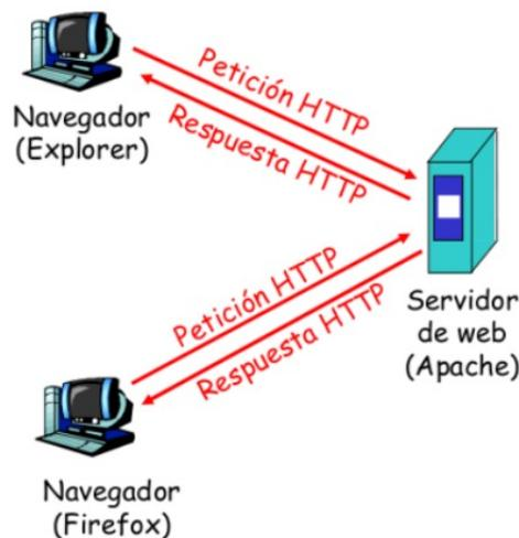
Figura 1.3: Comunicación cliente-servidor en HTTP
