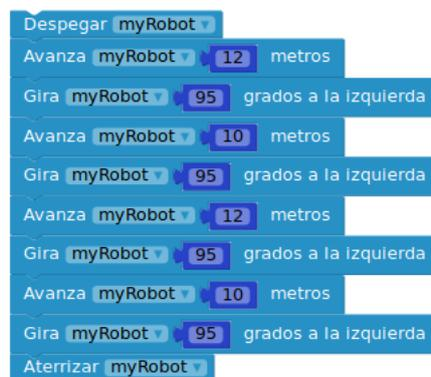
Figura 4.26: Solución en *Scratch* para el ejercicio cuadrado drone
