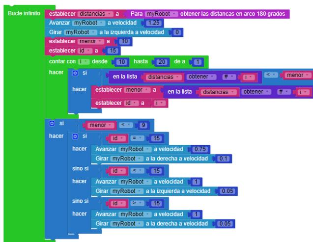
Figura 4.24: Solución en *Scratch* para el ejercicio atraviesa bosque
