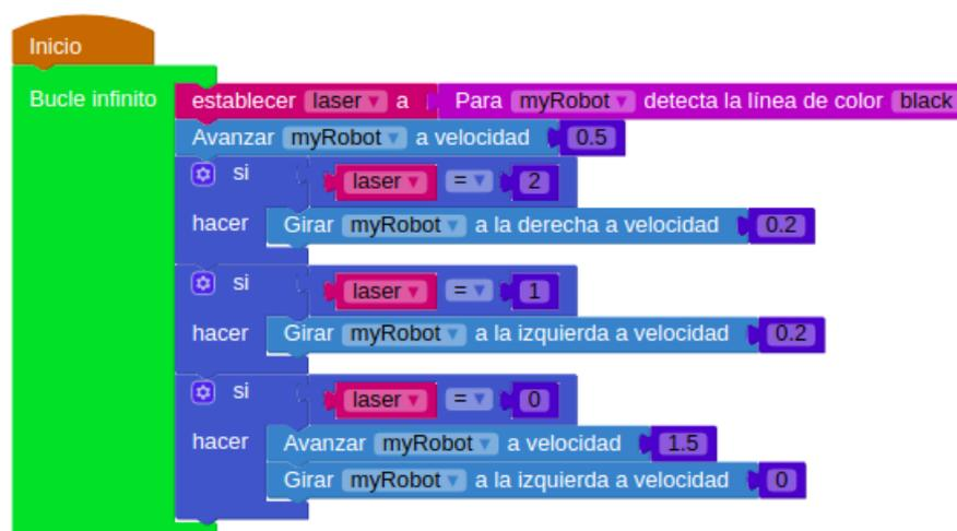
Figura 4.18: Solución en *Scratch* para el ejercicio sigue-líneas infrarrojos
