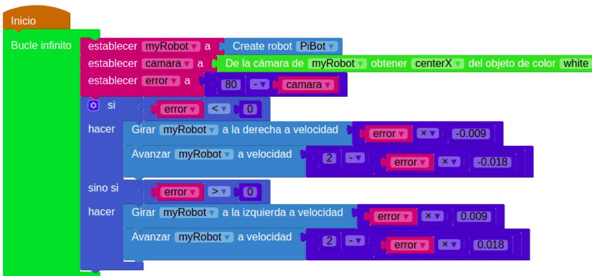
Figura 4.16: Solución en *Scratch* para el ejercicio sigue-líneas visión
