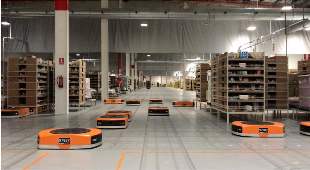
**Figura 1.4:** Ejemplo de almacén con vehículos móviles autónomos. [4]
