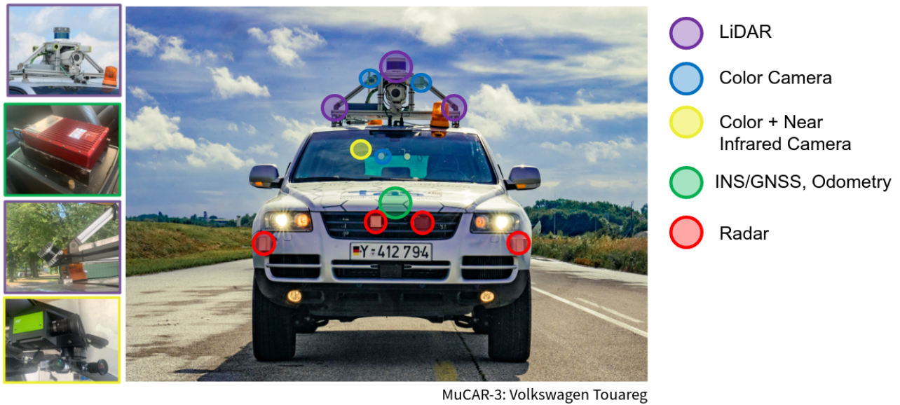
Figura 3.2: Vehículo de adquisición MuCAR-3. Obtenida de https://goose-dataset.de/docs/mucar3/ .
