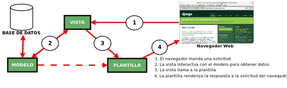
Figura 3.8: Esquema MVC Django.
