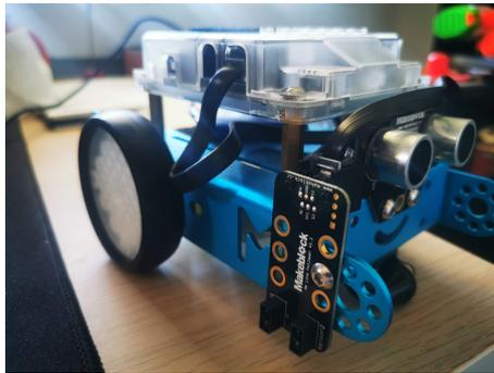
Figura 5.14: Preparación del mBot con el sensor sigue líneas lateral
