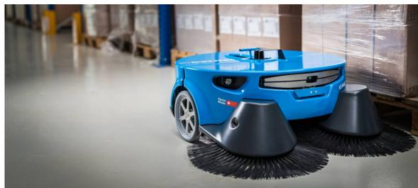
**Figura 1.4:** Robot de limpieza industrial K900 de la empresa Kemaro
