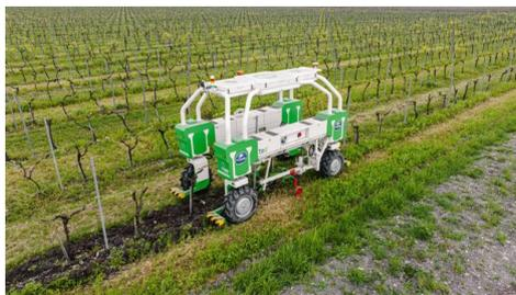
**Figura 1.1:** Robot de limpieza de viñedos de la empresa Naio Technologies
