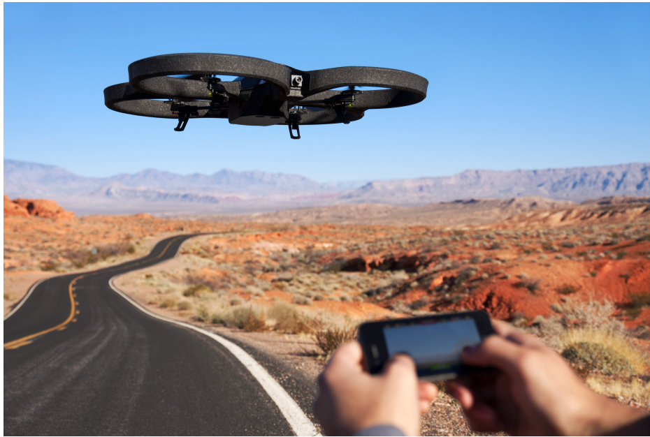
Figura 1.8: Sistema WiFi de control del drone de Parrot.
