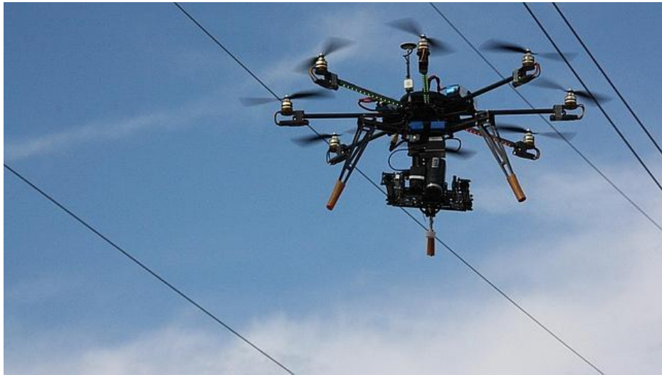
Figura 1.3: Drone de Endesa realizando labores de revisión.
