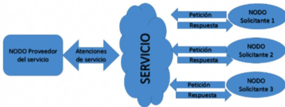
Figura 3.5: Estructura del sistema de comunicación por Servicios ROS
