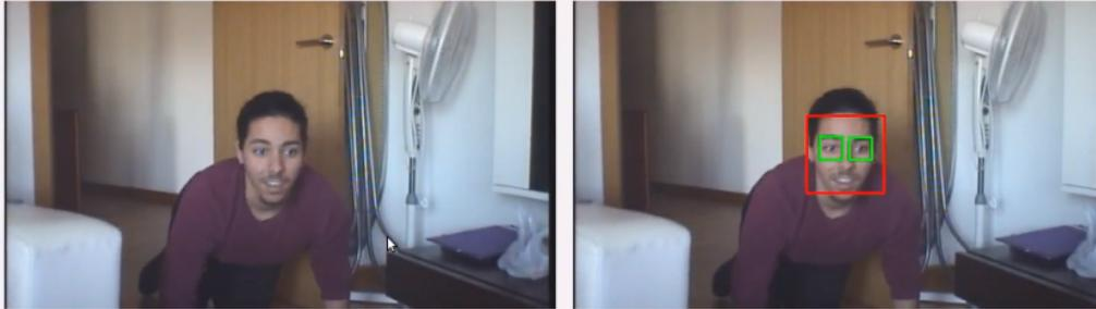
**Figura 3.6:** Herramientas de procesado con OpenCV: Segmentación de caras.
