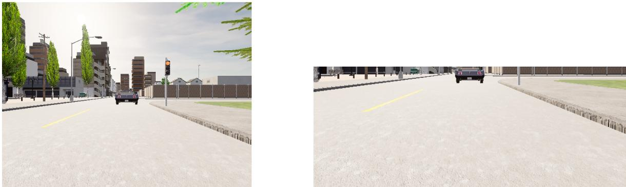
Figura 31: Izq.: Imagen RGB tomada por la cámara frontal del coche. Dcha.: imagen final cortada usada como entrada del modelo.
