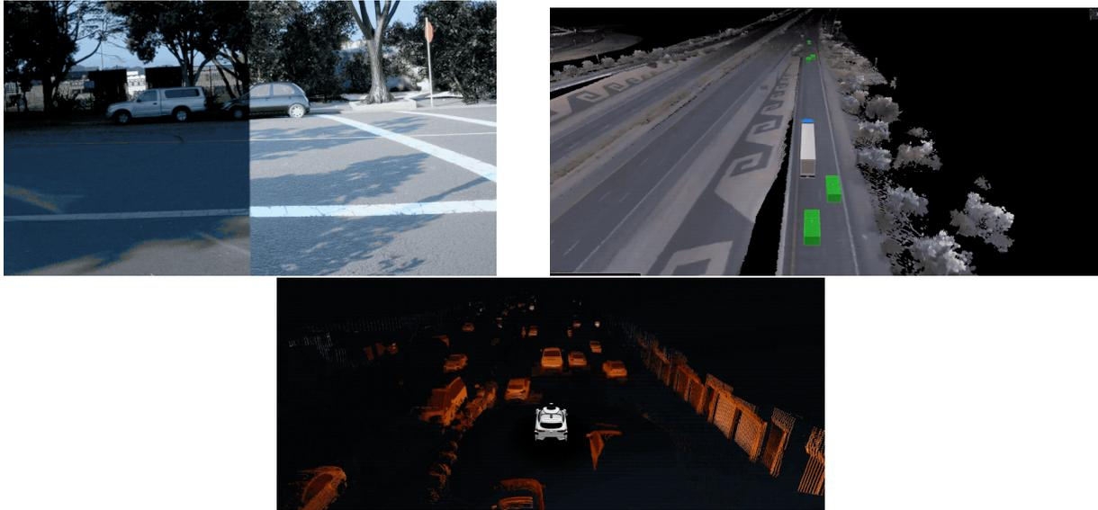
Figura 13: Simulador SimulationCity creado por Waymo. Mostrando el uso de sensores como el LIDAR, situaciones de tráfico con diferentes vehículos y un ejemplo de una cámara RGB frontal (arriba-izquierda) donde el lado izquierdo es el mundo real y el derecho el mundo simulado.
