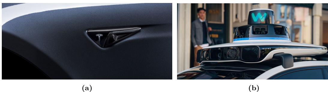
Figura 1.7: (a) Cámara del AutoPilot del Tesla, (b) Cámaras del coche Waymo de Google.
