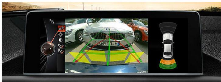
Figura 1.8: Cámara trasera de BMW para asistencia en el aparcamiento
