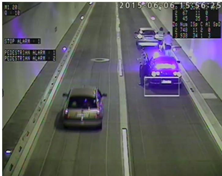
Figura 1.15: Sistema de detección de incidencias en túnel
