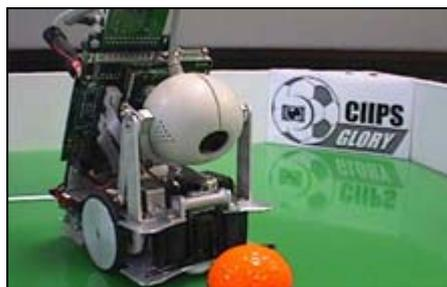
**Fig 1.5:** Robot EyeBot con sistema operativo ROBIOS
