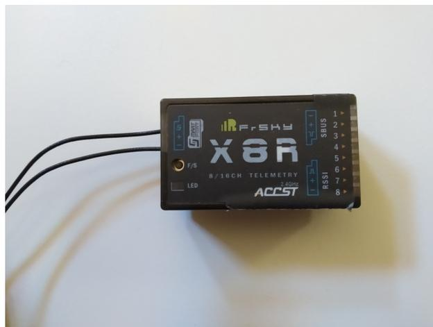
Fig. 2.2. Módulo receptor *FrSky X8R*.
