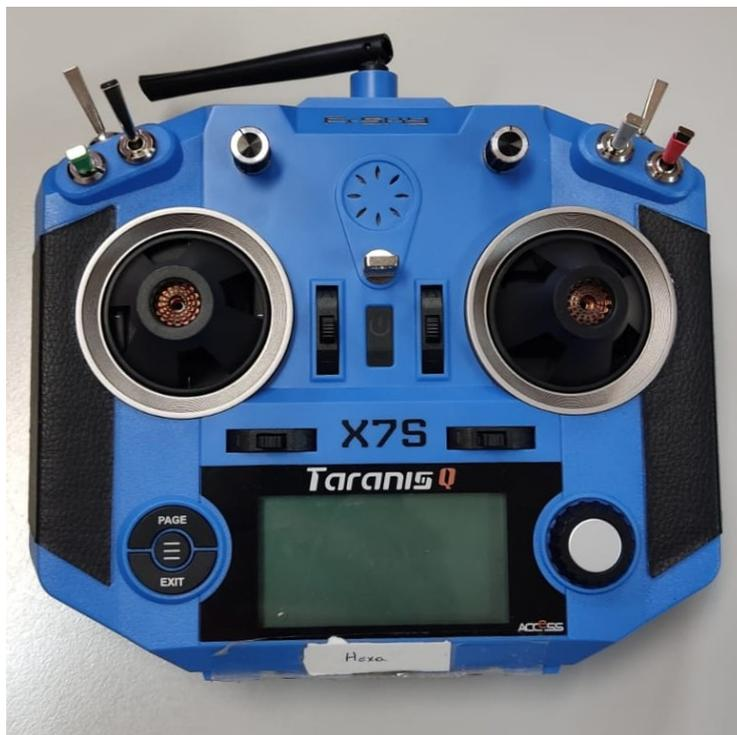
Fig. 2.1. Transmisor *Taranis Q X7S OpenTX*.
