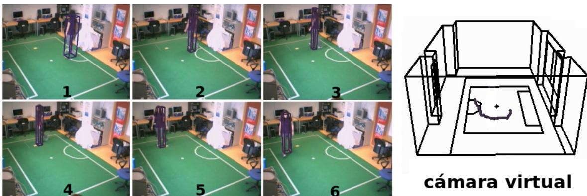
Figura 5.5: Eldercare siguiendo a una persona. Se muestran fotogramas de la cámara A y la trayectoria en la cámara virtual.
