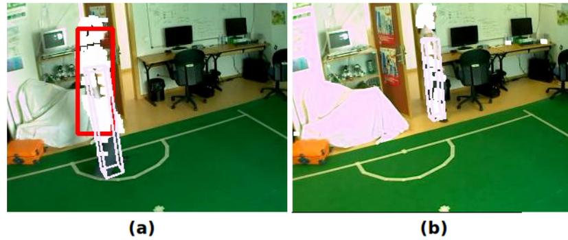
Figura 5.12: Filtro HSV de movimiento - (a) Sombras, (b) Cambio brusco de iluminación.
