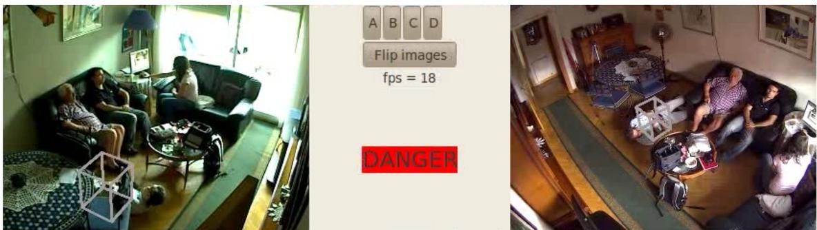
Figura 5.16: Detección de una caída con oclusión por el mobiliario (en escenario III).
