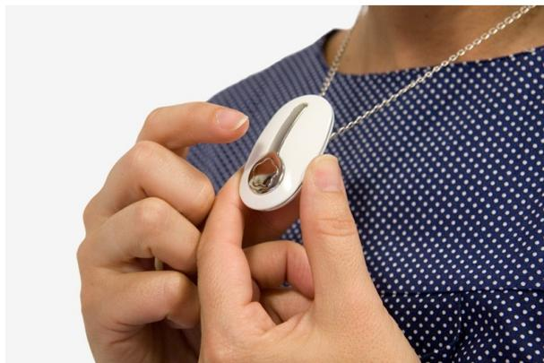
Figura 1.1: Sistema de teleasistencia con pulsador
