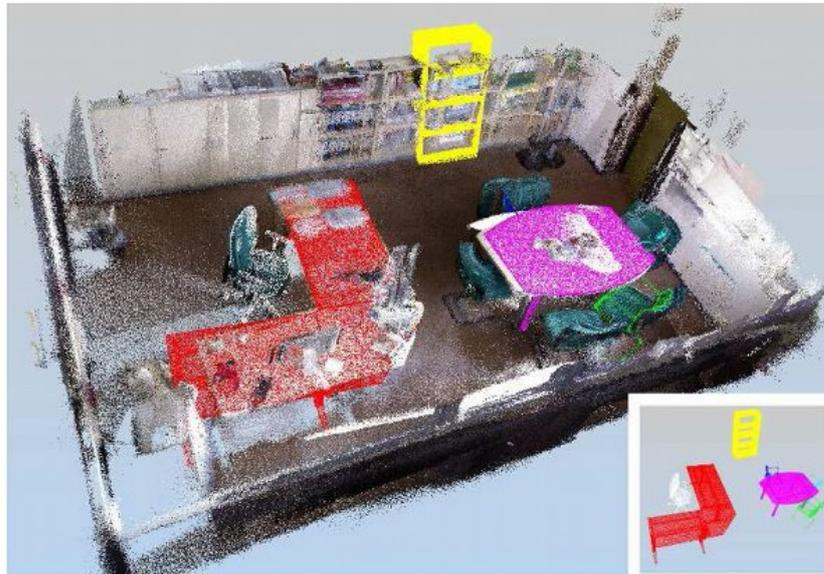
Figura 3.14: Ejemplo de segmentación con Point Cloud Library
