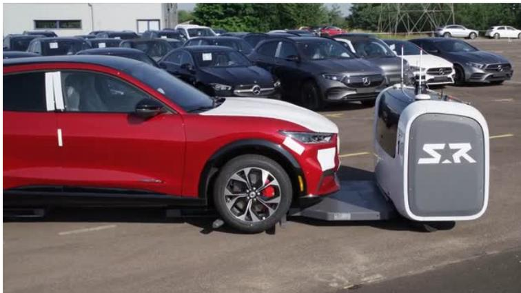
Figura 2: Aplicación de la robótica en el ámbito del automovilismo en la cual un robot es capaz de aparcar un coche de forma autónoma.
