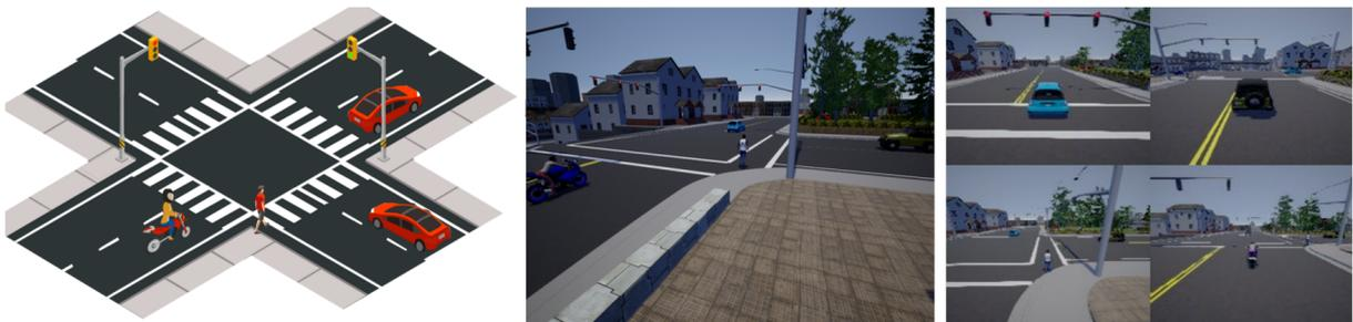
Figura 10: La Figura muestra un entorno de aprendizaje multiagente heterogéneo desarrollado utilizando MACAD-Gym. En la imagen de la izquierda, se presenta una visión panorámica del escenario en su conjunto. La imagen central representa el escenario simulado en detalle, y en la imagen de la derecha se muestran vistas focalizadas de las observaciones individuales de cada agente [26].
