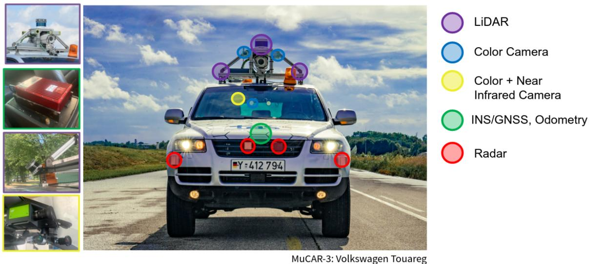
Figura 4.9: GOOSE. Sensores montados en MuCAR-3.
