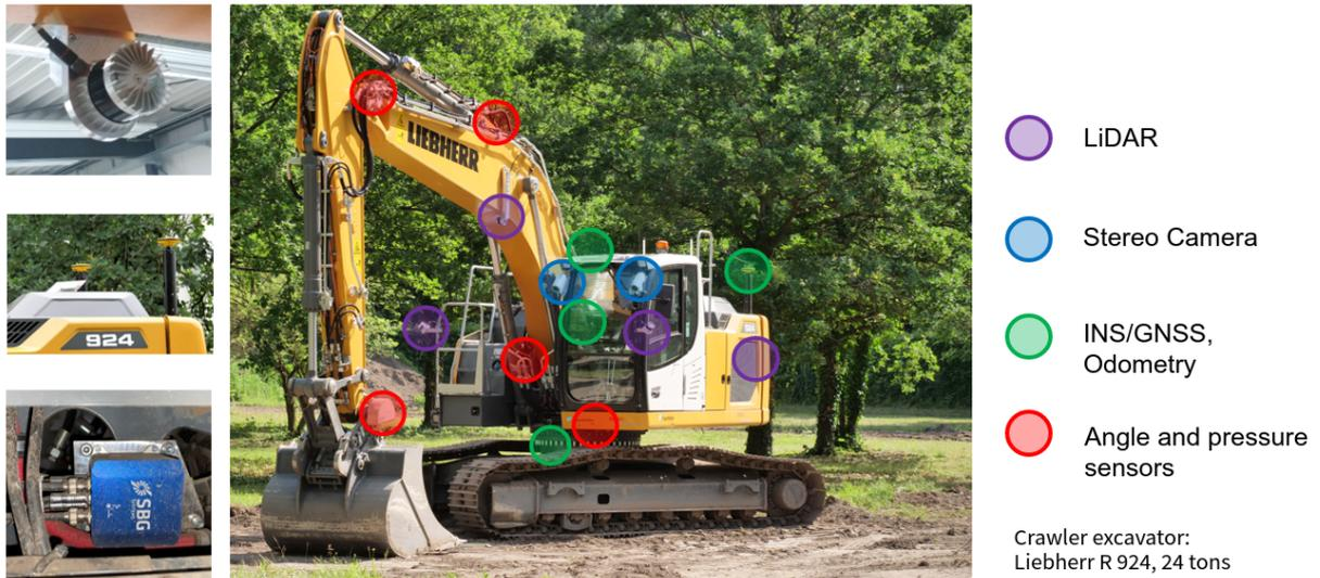
Figura 4.10: GOOSE. Sensores montados en Alice.
