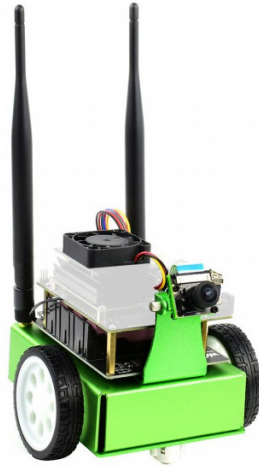
Figura 1.3: Robot para robótica educativa de Nvidia, Jetbot.
