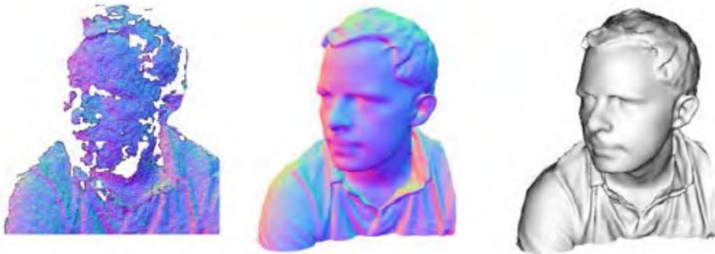
**Figura 3.6:** KinectFusion: A la izquierda la nube de puntos generada por el sensor. La imagen central y derecha corresponden a la reconstrucción del sistema a partir de la nube de puntos de entrada.
