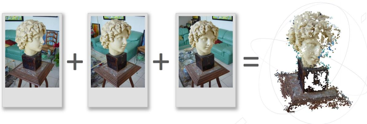
Figura 1.5: Reconstrucción 3D mediante *Structure from Motion*.
