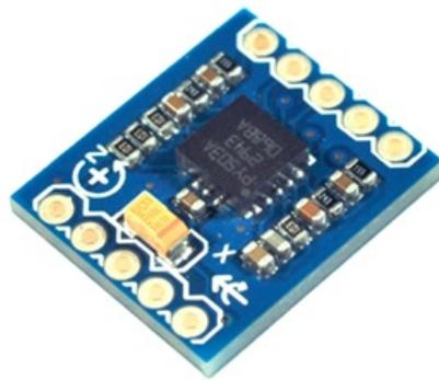
Figura 1.8: Ejemplo de una placa con un giroscopio.
