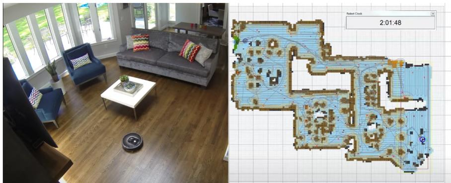
Figura 1.2: Ejemplo de la Roomba 980 recorriendo el entorno real (imagen izquierda) y construyendo el mapa del entorno (imagen derecha).
