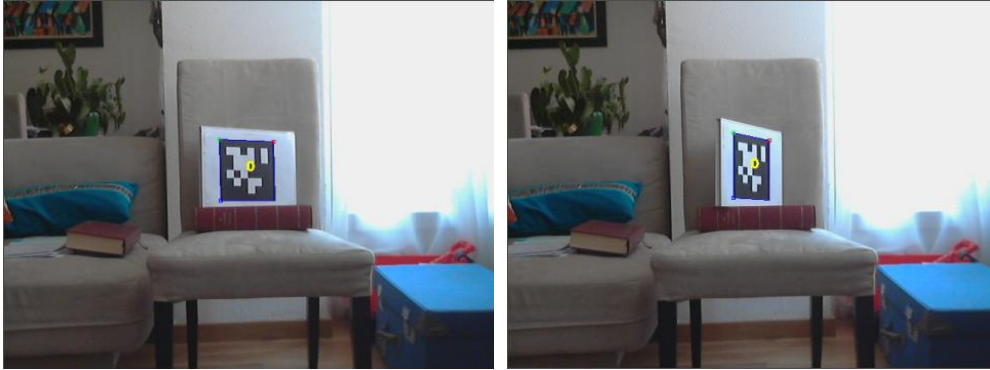
Figura 65 - Baliza a dos ángulos pitch distintos
