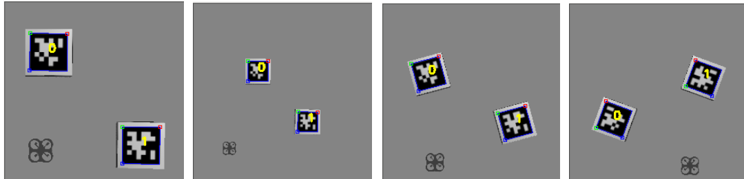
Figura 37 - Dos balizas a dos distancias y a dos ángulos yaw distintos
