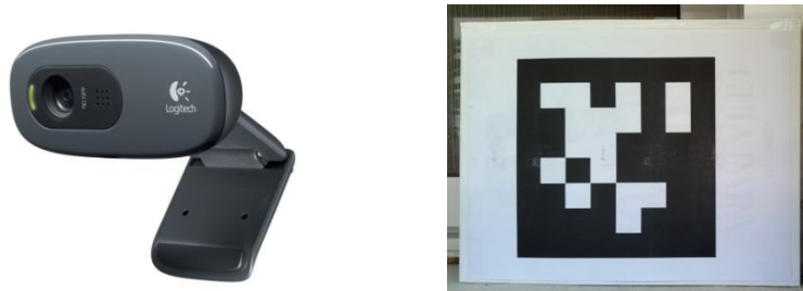
Figura 15 - Cámara web Logitech C270 y baliza AprilTags construida
