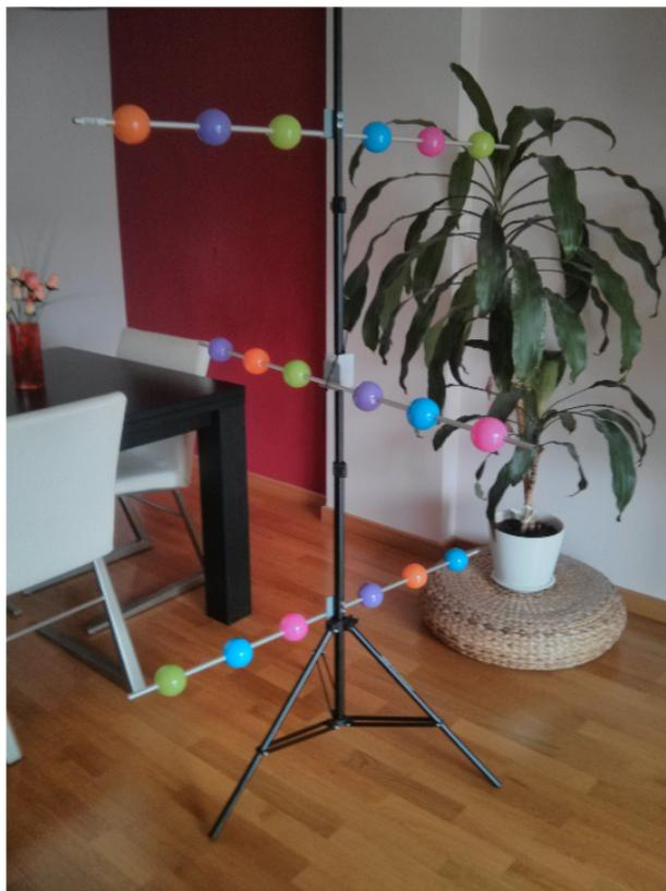
Figura 2.2: Patrón de calibración 3D
