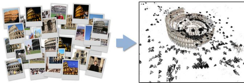
Figura 3.4: Reconstrucción del Coliseo de Roma mediante una técnica de SFM
