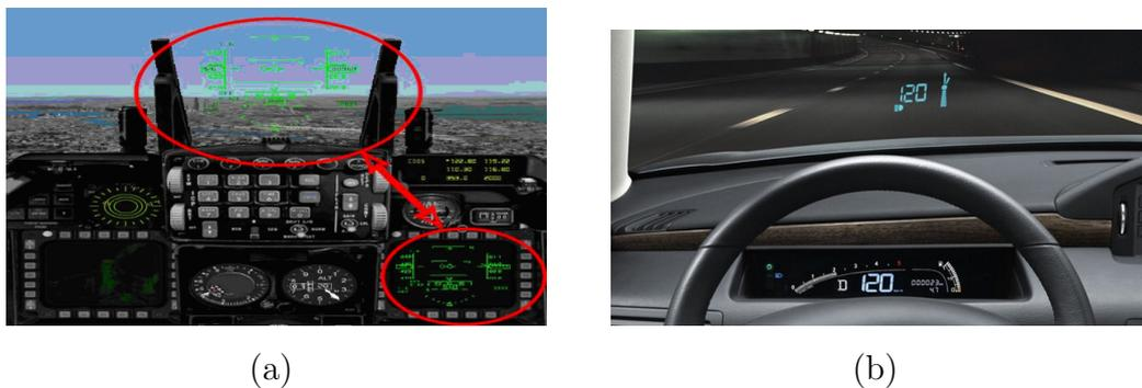
Figura 1.8: (a) Head-up displays de un avión de combate (b) Proyección de información en la luna de un coche
