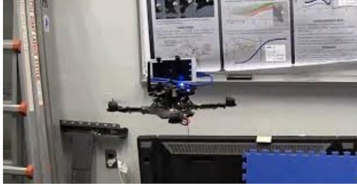
Figura 1.9: Dron equipado con dispositivo compatible con Tango
