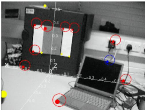
Figura 3.2: Ejemplo de puntos característicos tomados con MonoSLAM.
