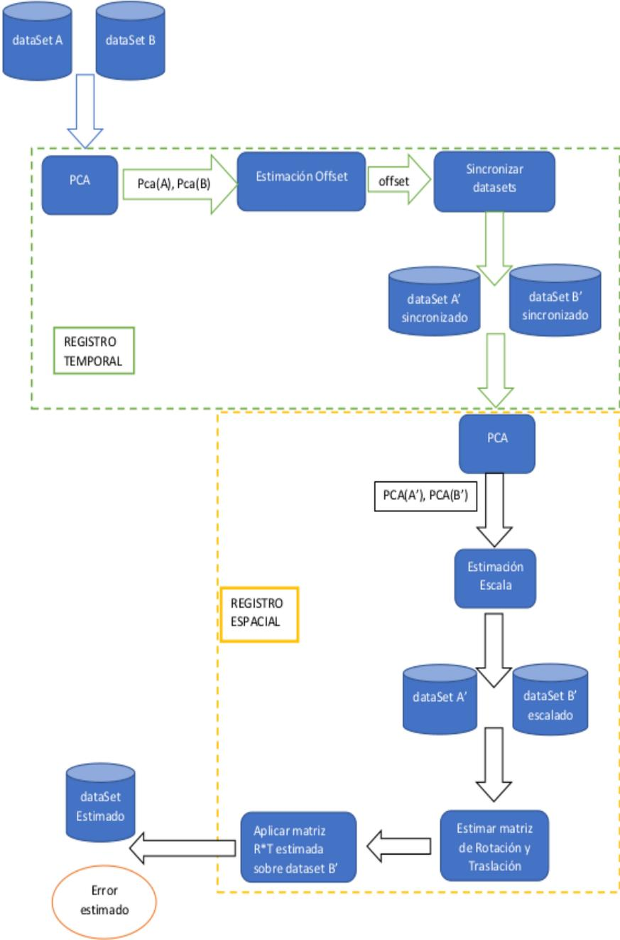
Figura 4.2: Diagrama de bloques de la herramienta SLAMTestbed
