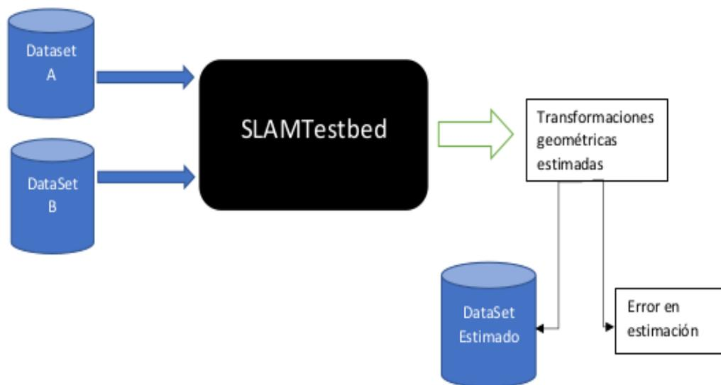
Figura 4.1: El diseño de caja negra de la herramienta SLAMTestbed.
