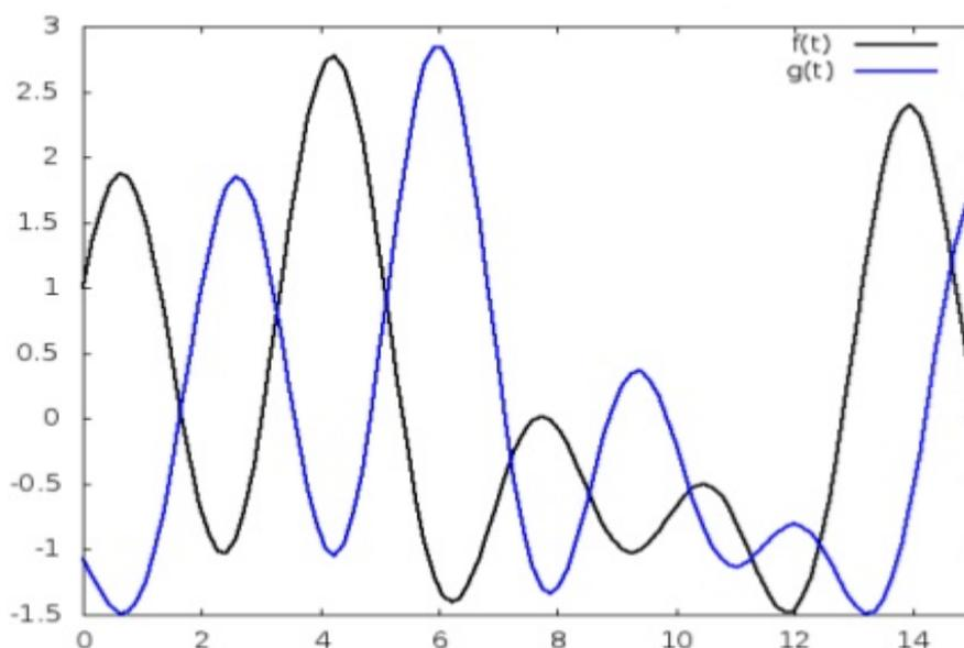
Figura 4.3: Desfase del offset entre dos series temporales.
