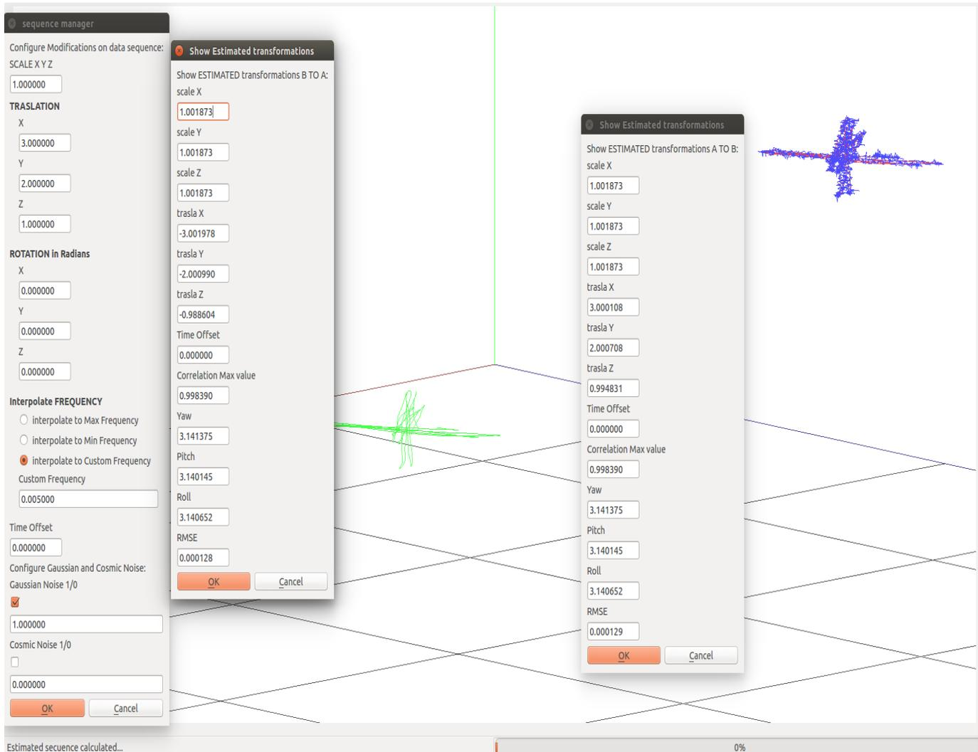
Figura 5.11: Resultados de la estimación de un cambio de traslación y ruido gaussiano.
