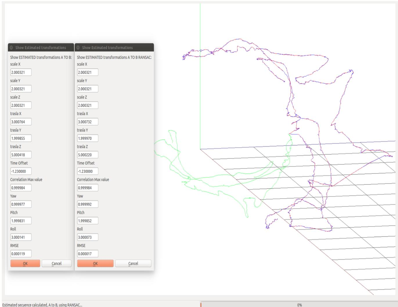
Figura 5.25: Resultados de la estimación B to A con ruido gaussiano y RANSAC
