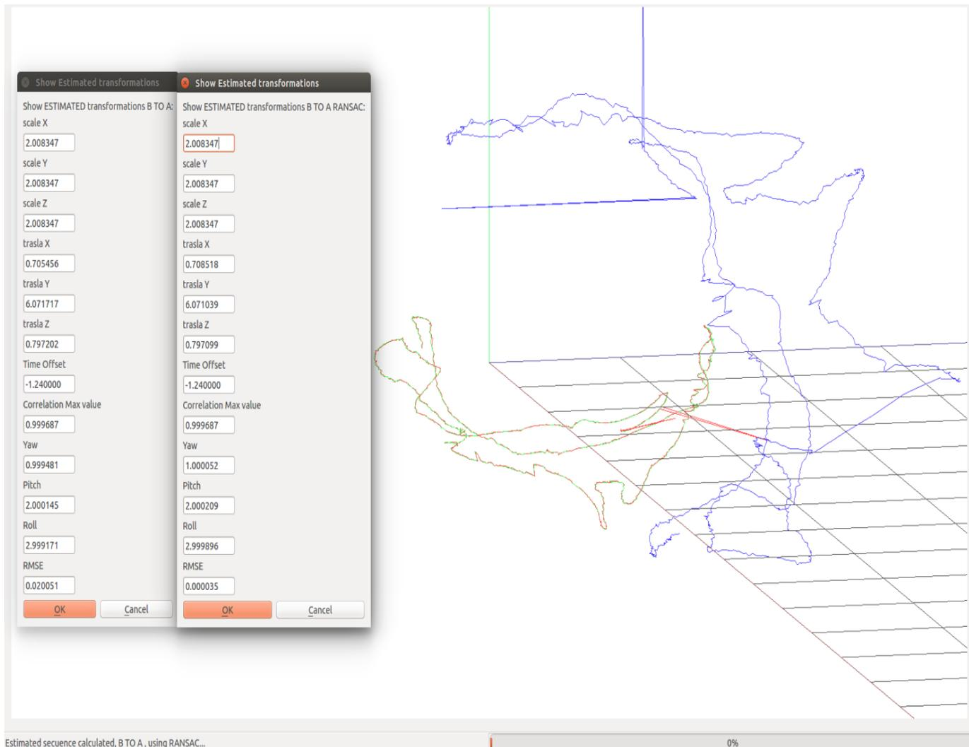
Figura 5.28: Resultados de la estimaciones B to A con ruido cósmico y RANSAC.
