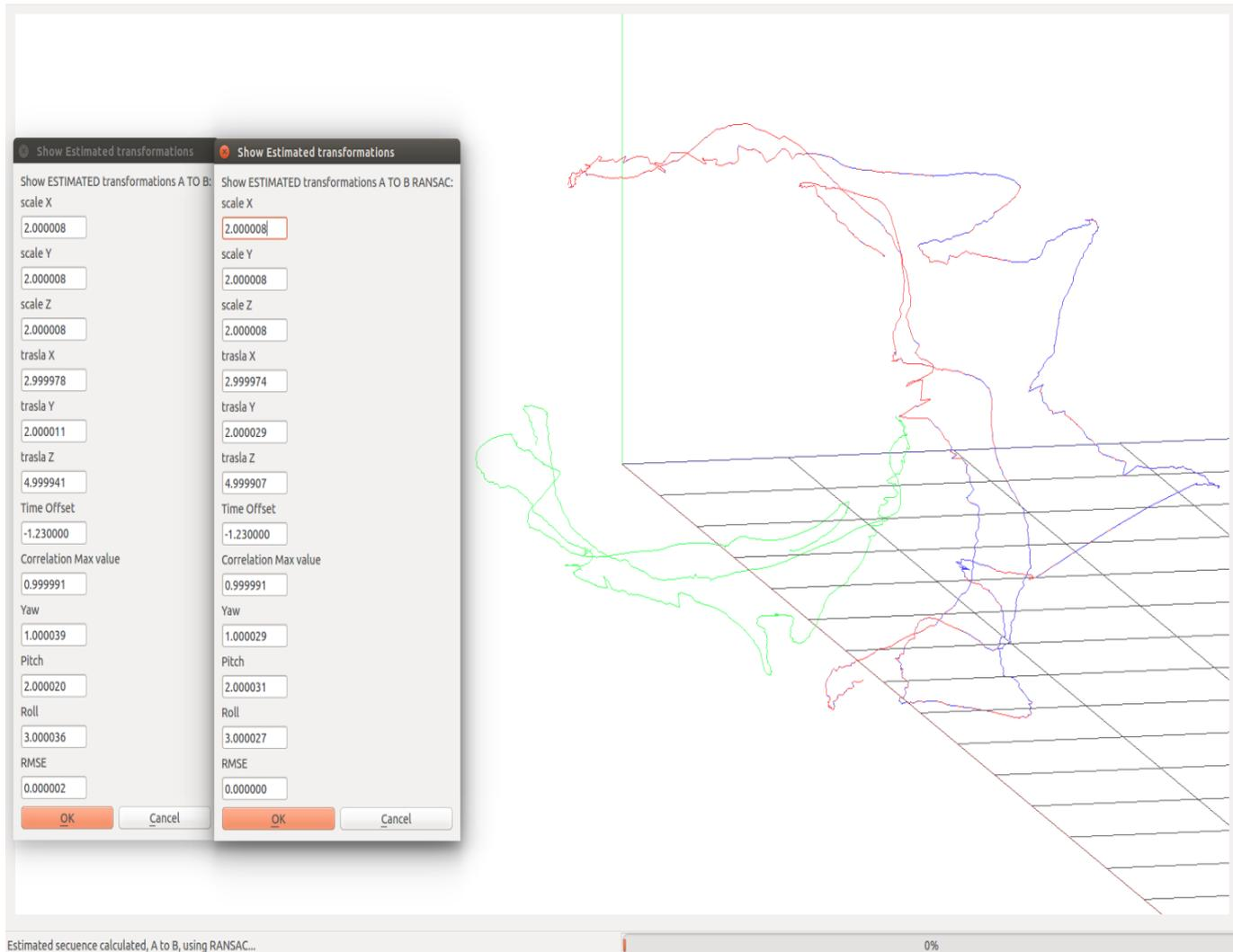
Figura 5.23: Resultados de las estimaciones A to B, sin RANSAC y con RANSAC.
