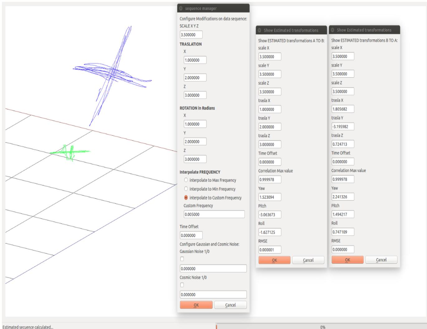
Figura 5.16: Resultados de la estimación de un cambio de escala, traslación y rotación.
