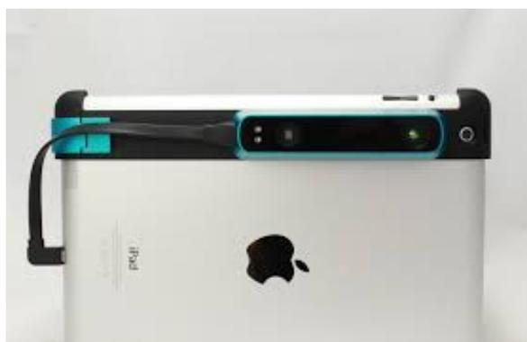
Figura 1.7: El sensor de profundidad Structure para Ipad.
