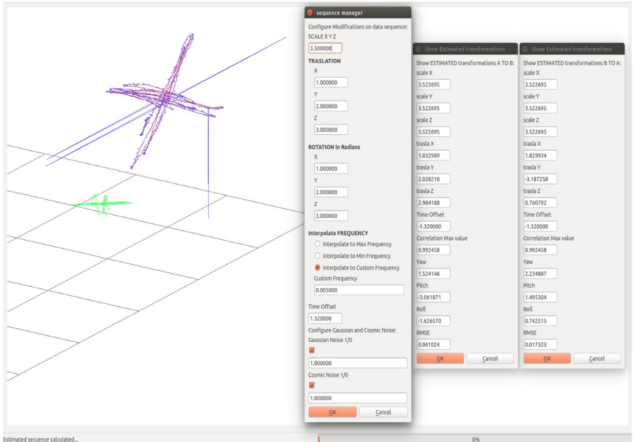
Figura 4.5: Resultados de la estimación de un cambio de escala y traslación .
