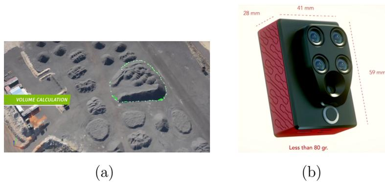
Figura 1.5: Pix4D cálculo de volumen(a). Cámara multispectral Parrot Sequoia (b)
