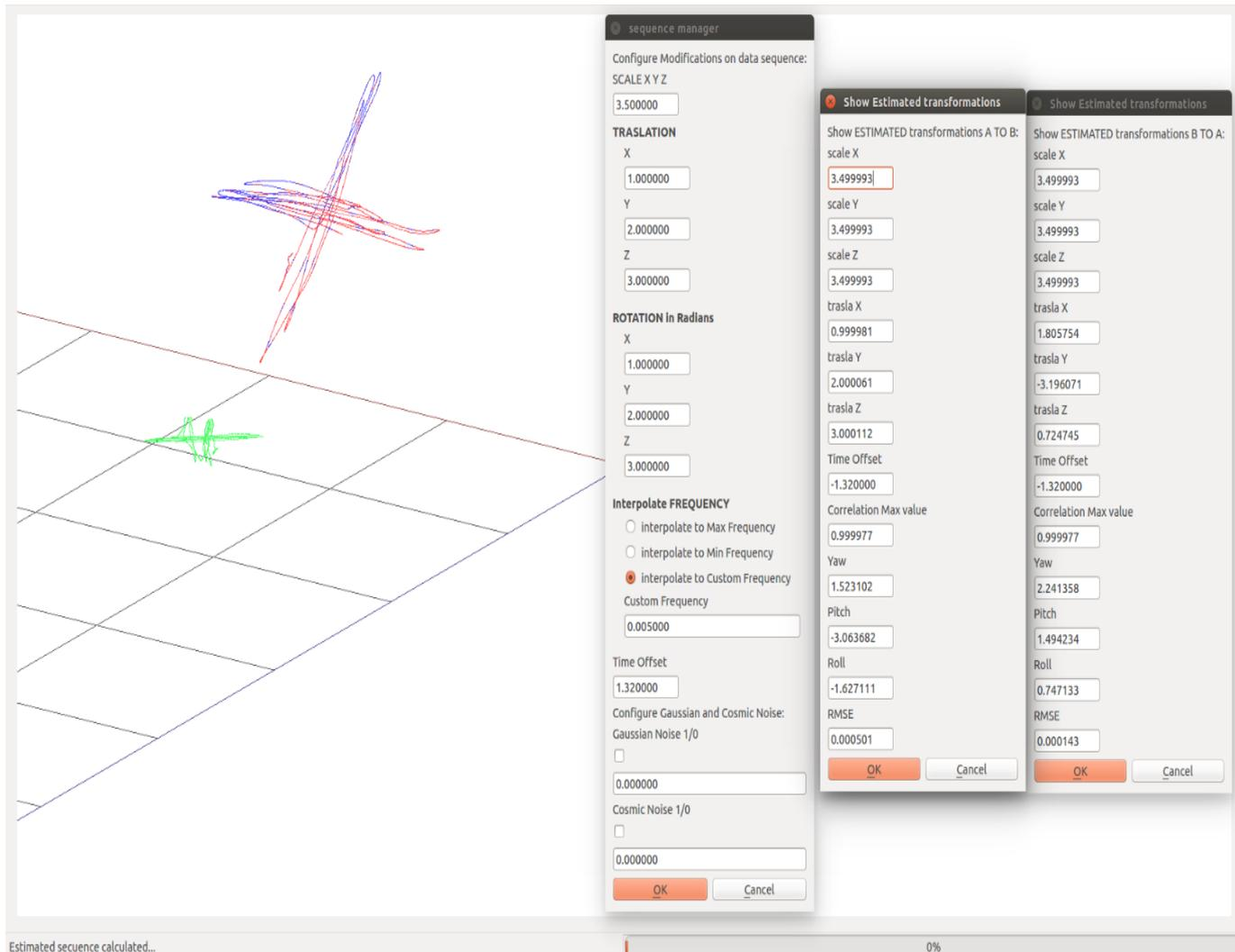
Figura 5.17: Resultados de la estimación de un cambio de escala, traslación, rotación y offset simultáneos
