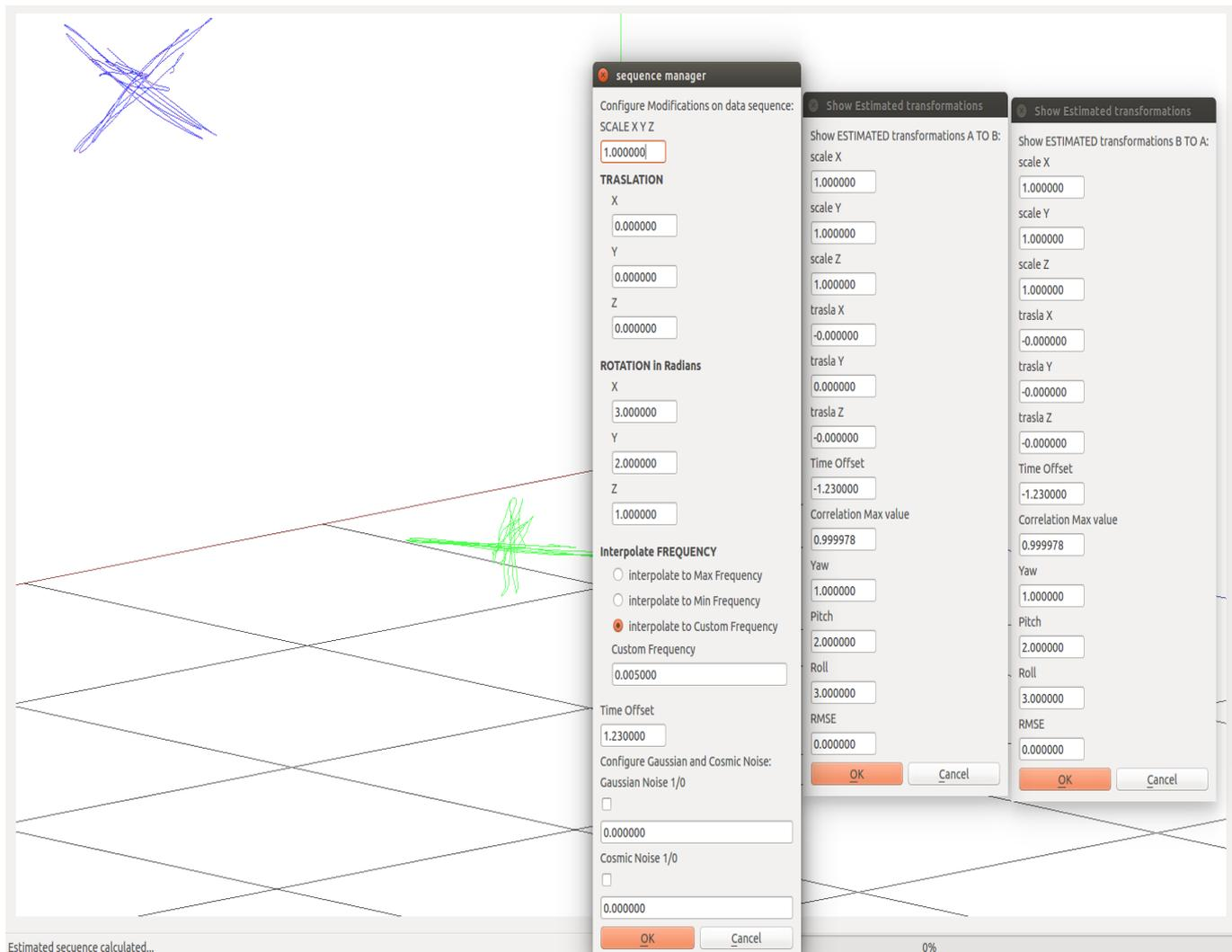
Figura 5.13: Resultados de la estimación de un cambio de rotación y offset.
