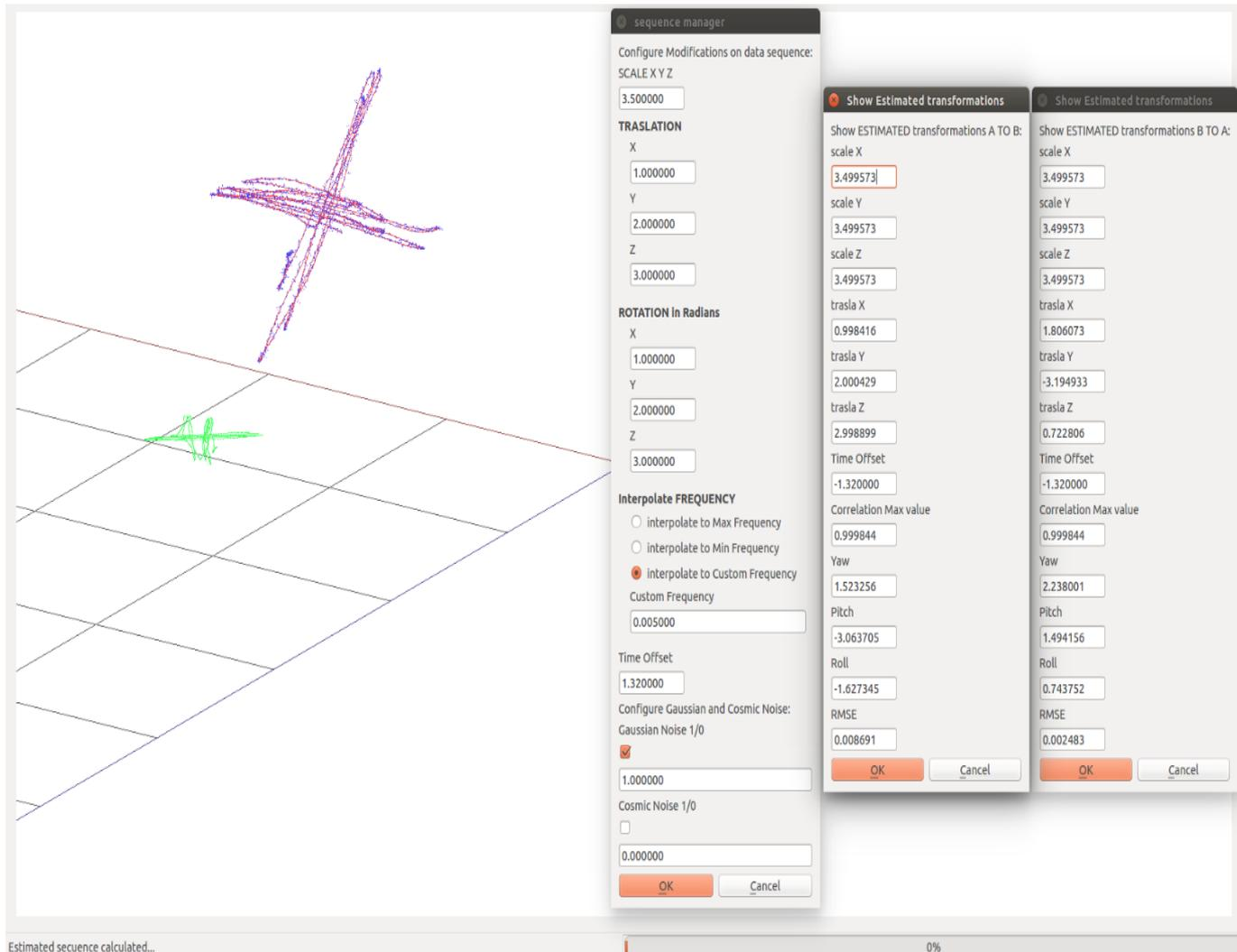
Figura 5.18: Resultados de la estimación de un cambio de escala y traslación, rotación, offset y ruido gaussiano simultáneos.
