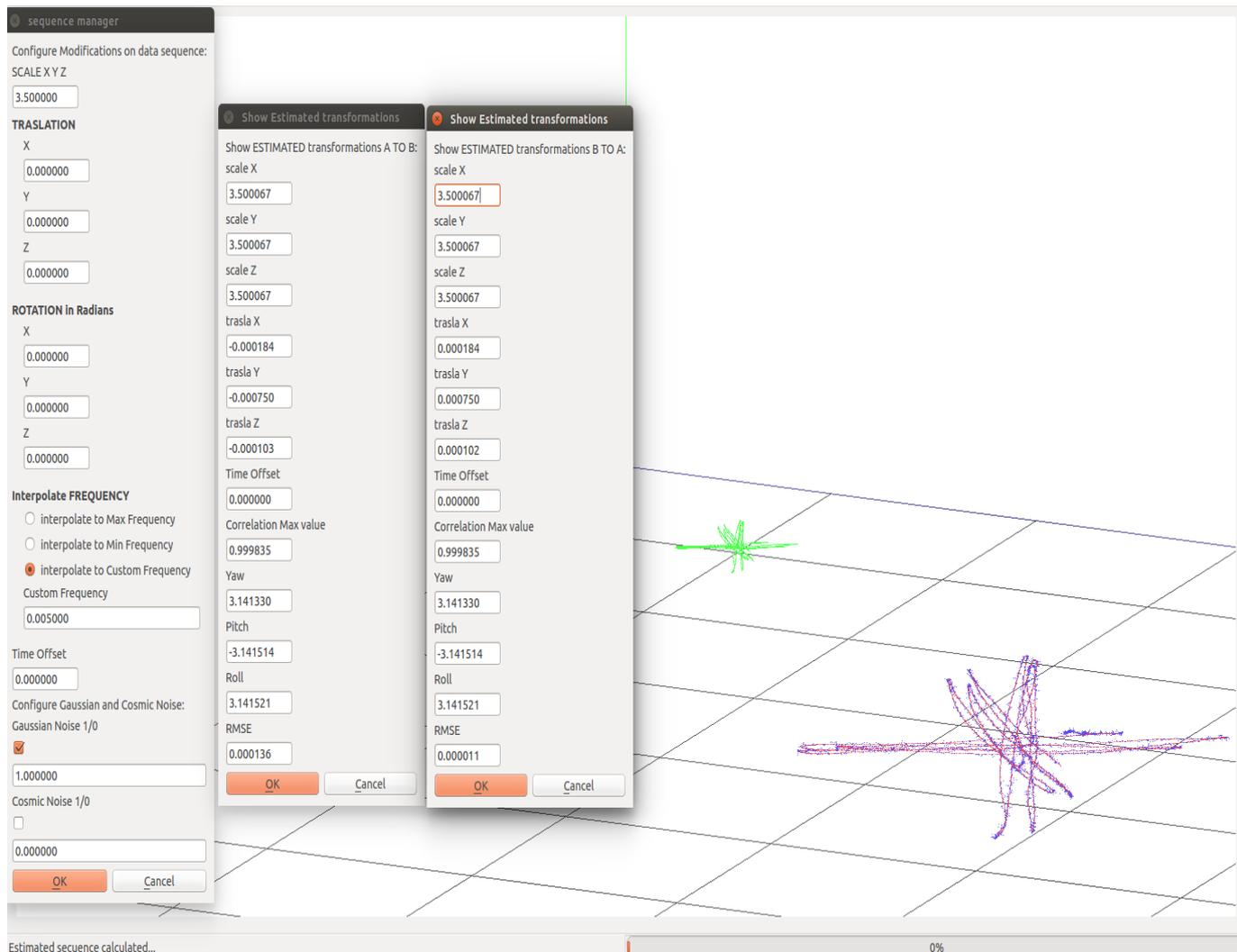
Figura 5.7: Resultados de la estimación de un cambio de escala y ruido gaussiano .
