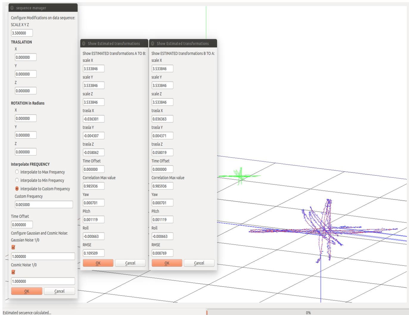
Figura 5.8: Resultados de la estimación de un cambio de escala con ruido gaussiano y cósmico
