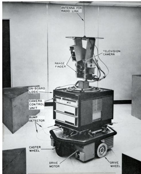
Figura 1.1: Robot Shakey. En los albores de la Visión Artificial
