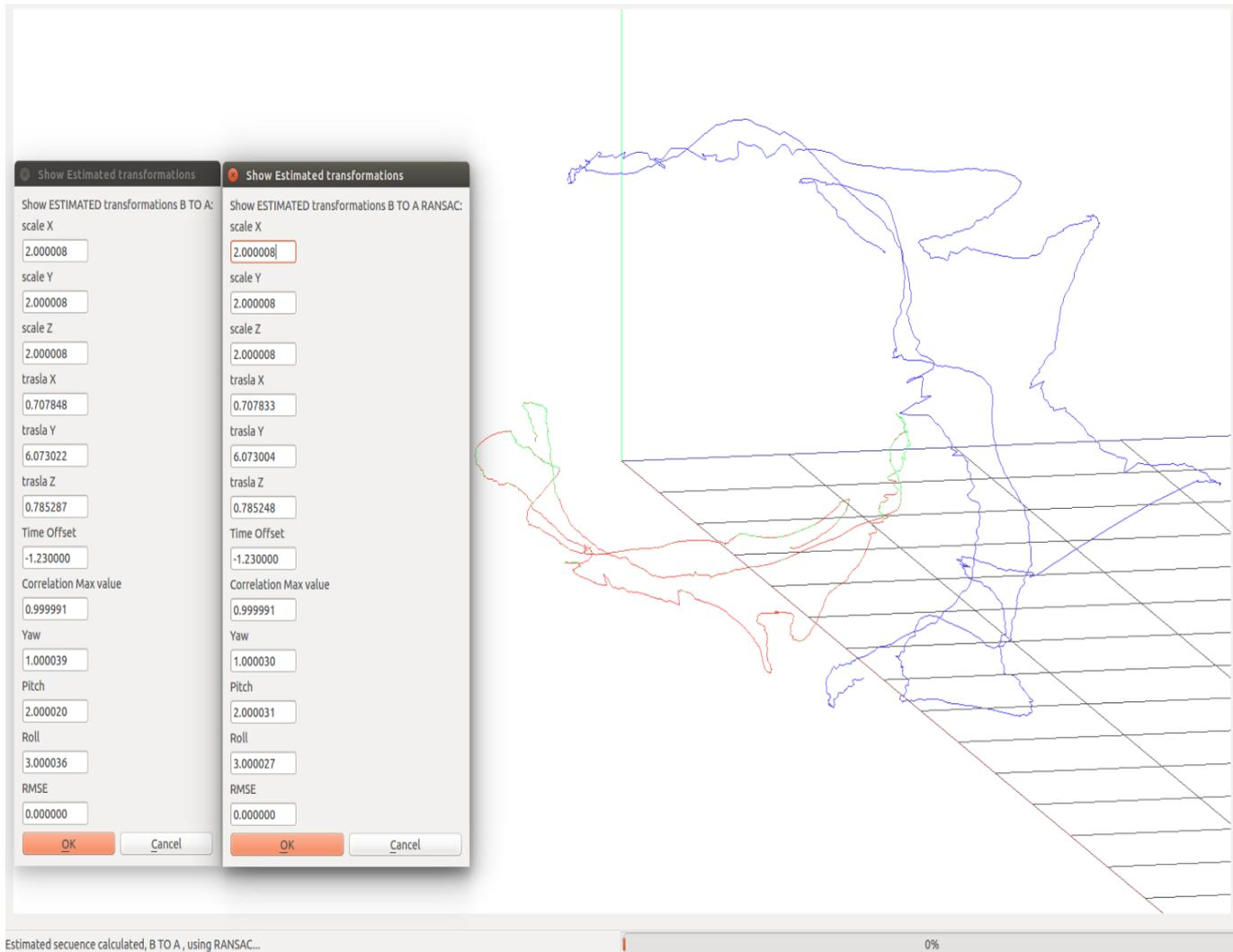
Figura 5.24: Resultados de las estimaciones B to A, sin RANSAC y con RANSAC.
