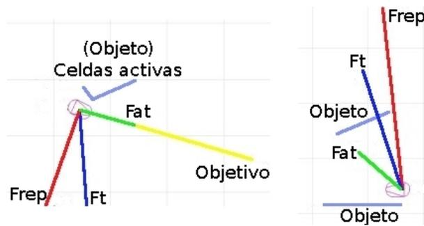
Figura 6.21: Concepto de VFF. Proximidad de obstáculo (pared) y acción de las fuerzas ejercidas por las celdas ocupadas.
