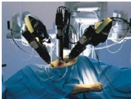
Figura 1.5: Robot cirujano *Da Vinci* en una operación.
