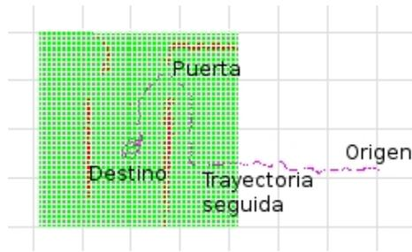
Figura 6.14: Navegación GPP. Actuación del robot al salir por una puerta.
