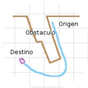
Figura 6.30: Comportamiento con ventana de seguridad ante la proximidad de un obstáculo.
