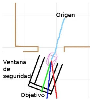
Figura 6.31: Comportamiento con ventana de seguridad ante una puerta.
