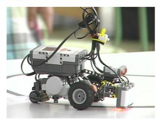
Figure 6: Robot Lego NXT diseñado y programado para seguir una línea.
