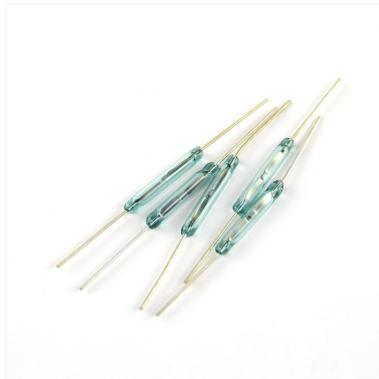
Figura 1: Interruptor de lengüeta o reed switch incluido en el kit. Imagen de *robotshop.com*
