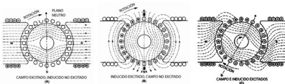
Figura: extraídas del libro *Máquinas eléctricas*. Reacción del inducido
