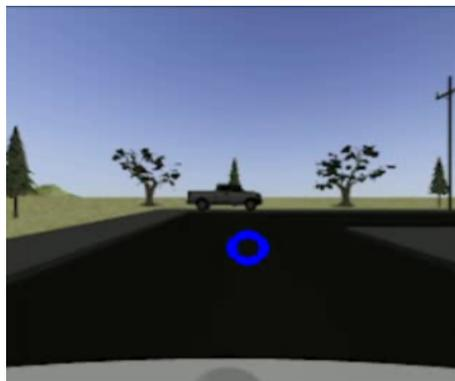
Figura 4.10: Salida de la red neuronal *ResNet-18* en el simulador *Gazebo*.
