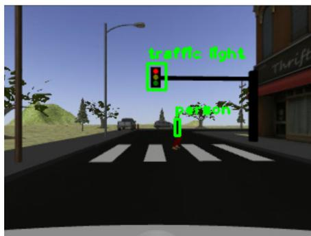
Figura 4.11: Salida de la red neuronal *YOLO V3 Tiny* en el simulador *Gazebo*.
