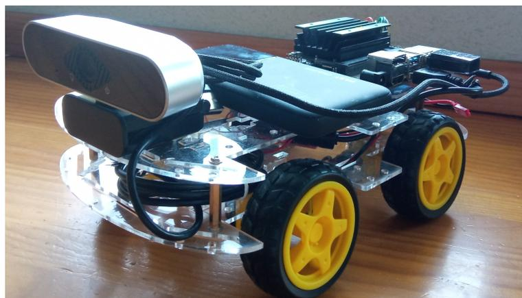
Figura 4.15: Robot con *NVIDIA Jetson Nano*.
