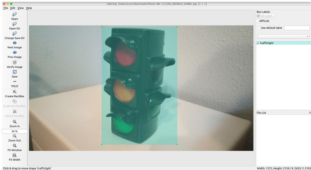
Figura 4.20: Etiquetado de objetos propios con la herramienta *LabelIMG*.
