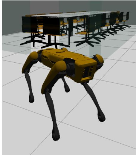
Figura 3.10: Robot Spot de Boston Dynamics simulado en *Gazebo*.
