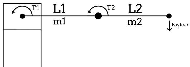
Figura 5.8: Dinámica del manipulador completamente extendido
