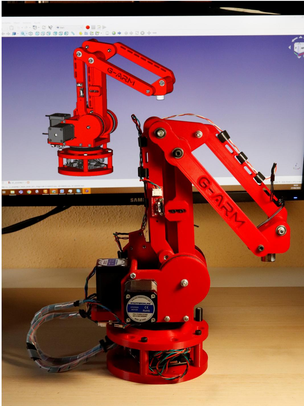
Figura 5.26: Montaje real del robot
