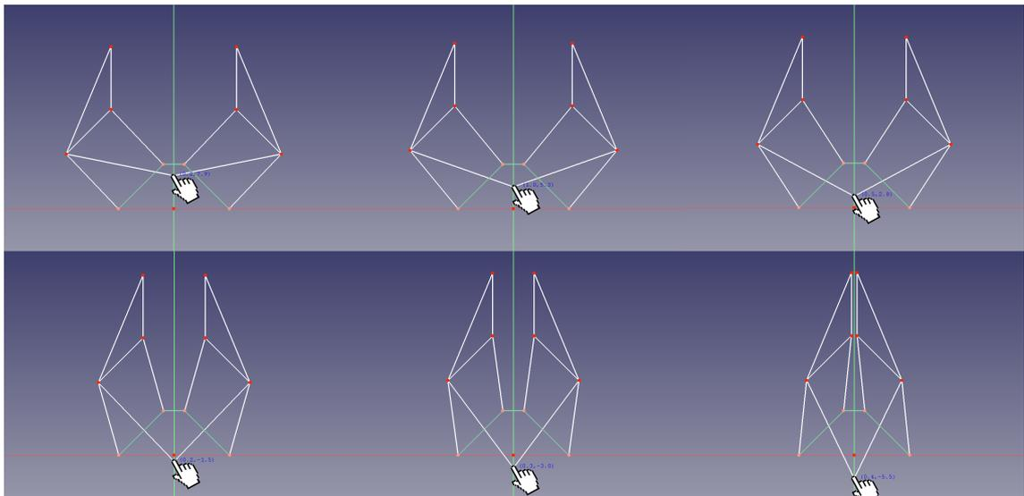
Figura 5.3: Pinza paralela con 1 grado de libertad
