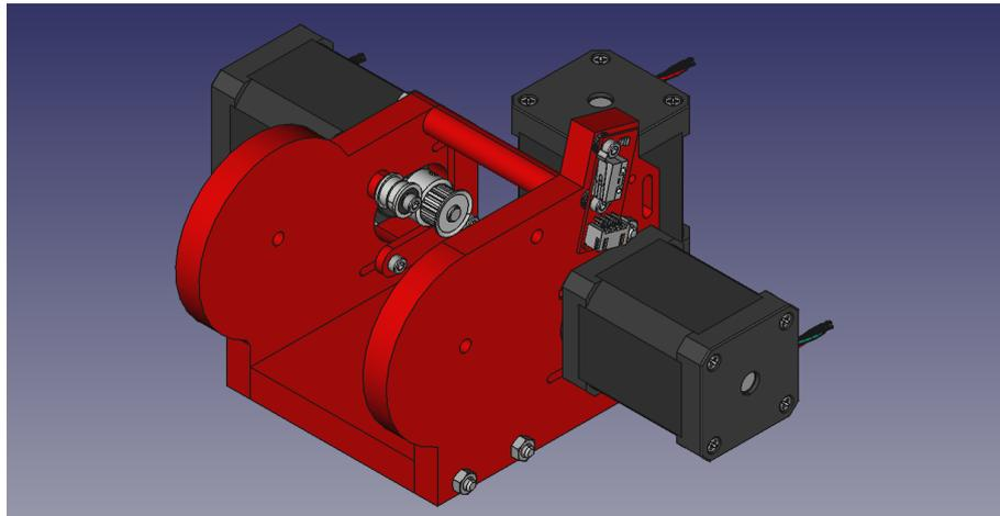
Figura 5.17: Base de los motores
