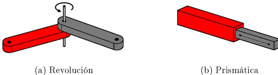
Figura 5.2: Tipos de articulaciones más usadas en robótica
