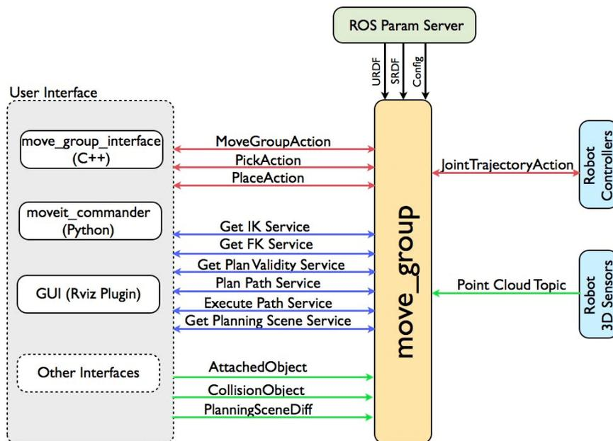
Figura 6.8: Relación de *move\_group* con el resto del *Firmware*
