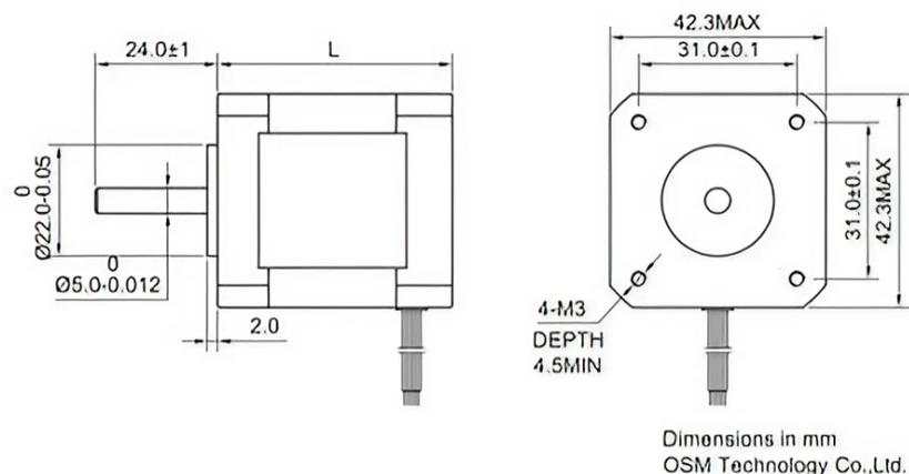
Figura 5.9: Dimensiones de los motores Nema17
