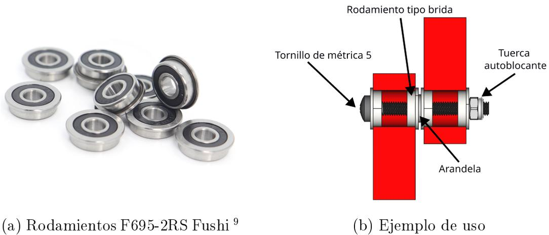
Figura 5.13: Rodamientos de tipo brida
