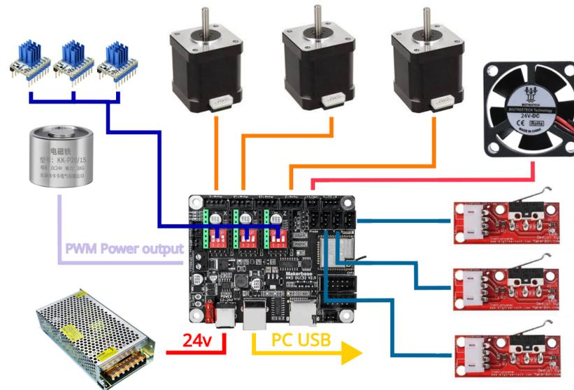
Figura 4.5: Esquema de la arquitectura hardware
