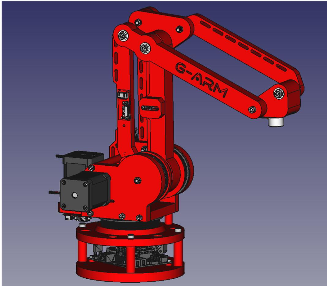
Figura 5.25: Ensamble CAD completo del robot final
