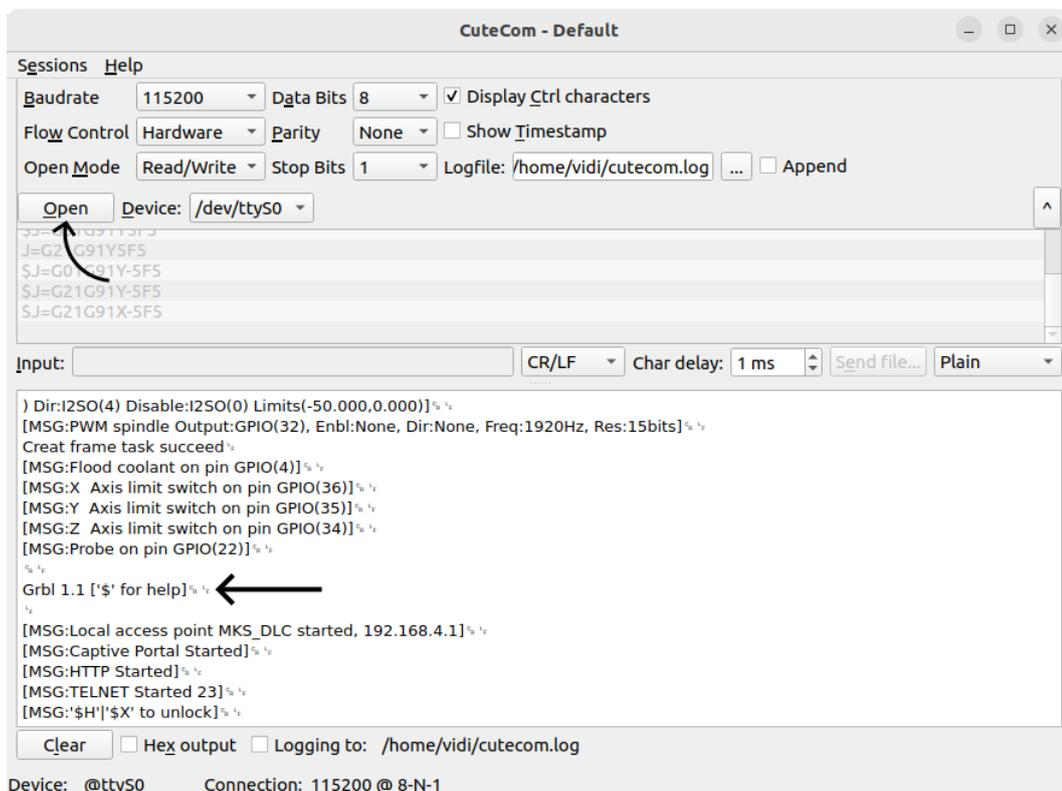
Figura 6.1: Terminal gráfica de Cutecom al conectarse a una placa con Grbl
