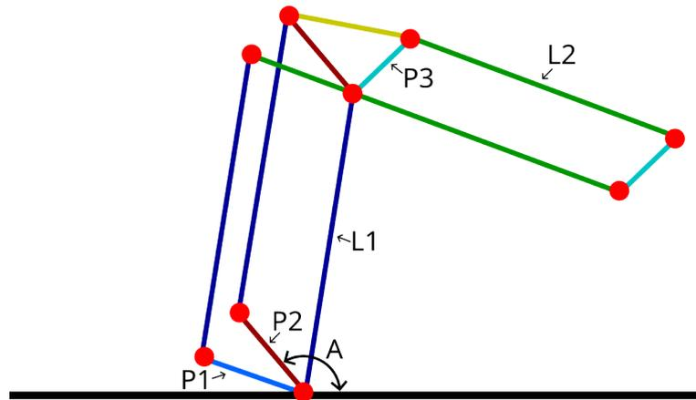
Figura 5.4: Principio fundamental del brazo MeArm
