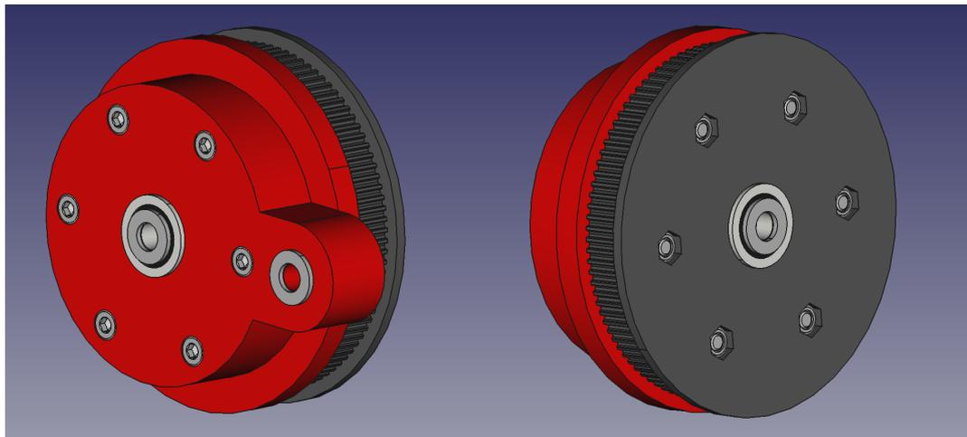
Figura 5.20: Ambos lados de la palanca de la articulación 3
