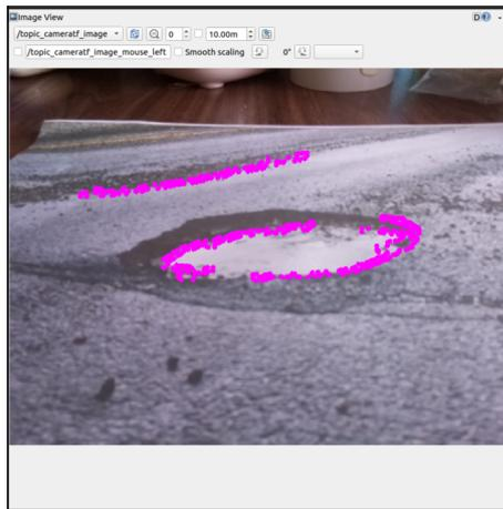
Figura 7.5: Primera versión en la obtención del contorno del bache
