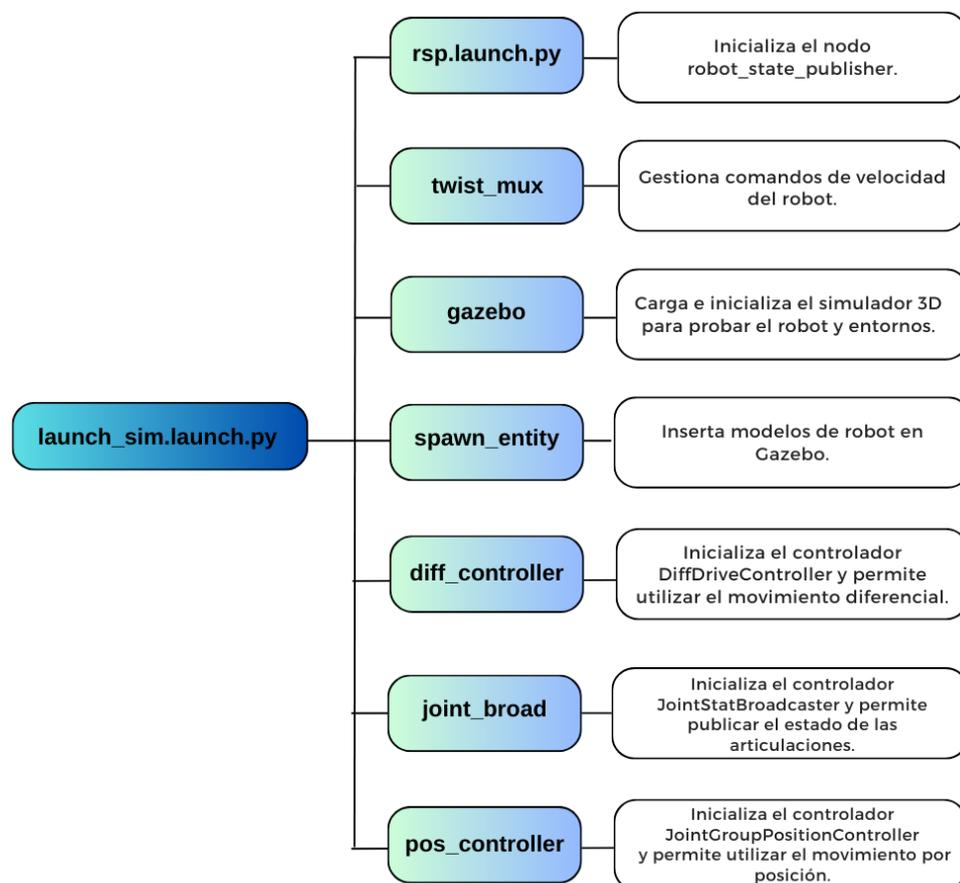
Figura 6.4: Esquema de `launch_sim.launch.py`
