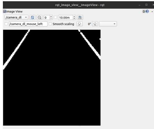
Figura 6.25: Filtro resultante aplicado para la detección de líneas
