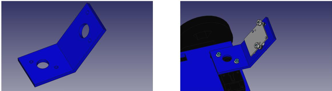
Figura 5.9: Distintas vistas del soporte de la cámara
