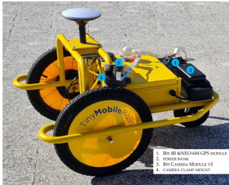
Figura 2.1: Robot usado para la reconstrucción 3D de baches
