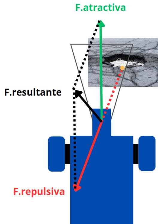
Figura 6.27: Diagrama de fuerzas del algoritmo VFF
