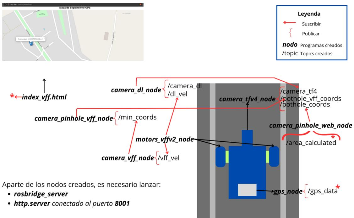
Figura 7.12: Esquema de nodos para el modo autónomo
