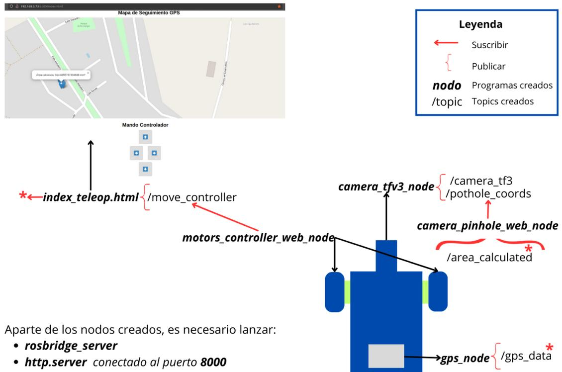
Figura 7.10: Esquema de nodos para el modo teleoperado
