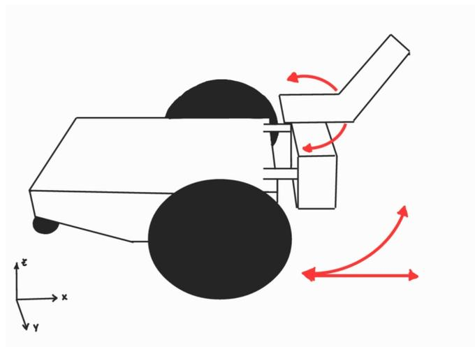
Figura 5.2: Esquema de los grados de libertad de PiBot
