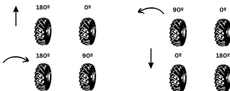
Figura 6.13: Distintas direcciones de las ruedas de PiBotJ
