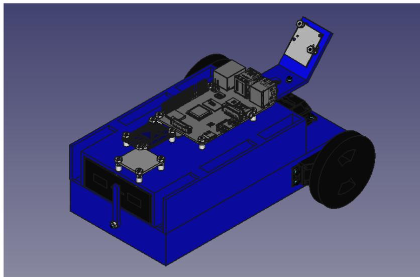
Figura 5.14: Robot completo montado en FreeCAD
