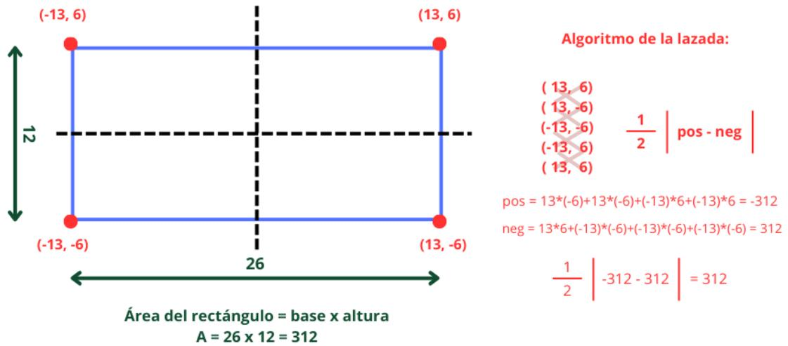
Figura 6.22: Demostración del algoritmo de la lazada
