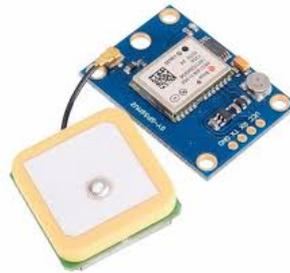
Figura 4.3: Módulo GPS NEO 6M<sup>27</sup>
