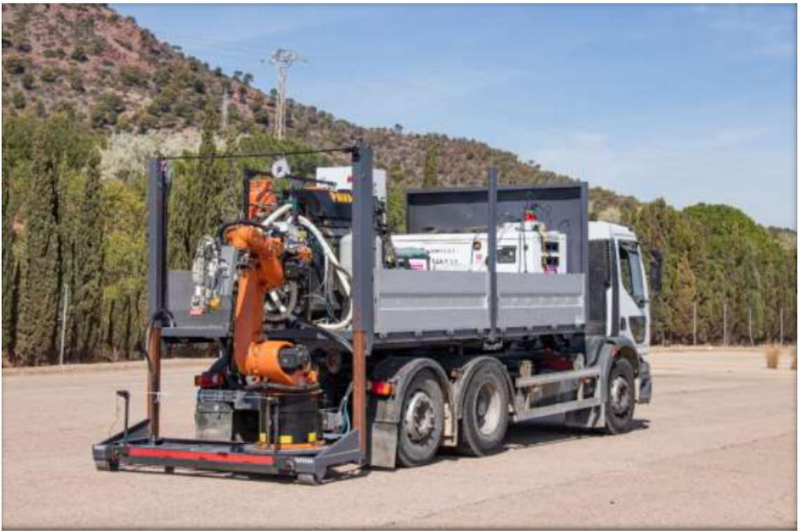
Figura 2.4: Plataforma robótica diseñada para el sellado de grietas
