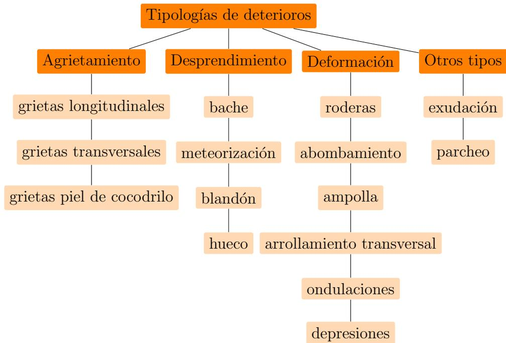
Figura 1.9: Clasificación de deterioros
