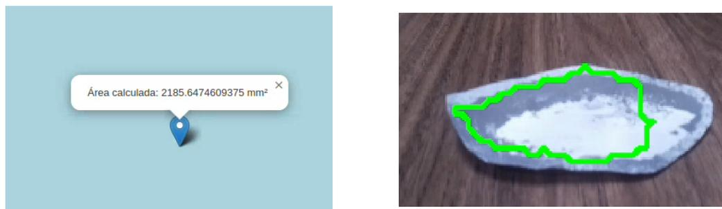
Figura 7.8: Captura del vídeo que calcula el área usando el algoritmo de la lazada
