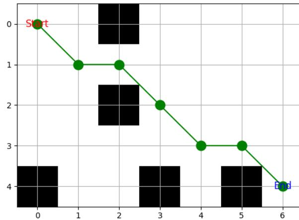
Figura 5.11: Ejemplo de búsqueda hacia un objetivo con A\*.
