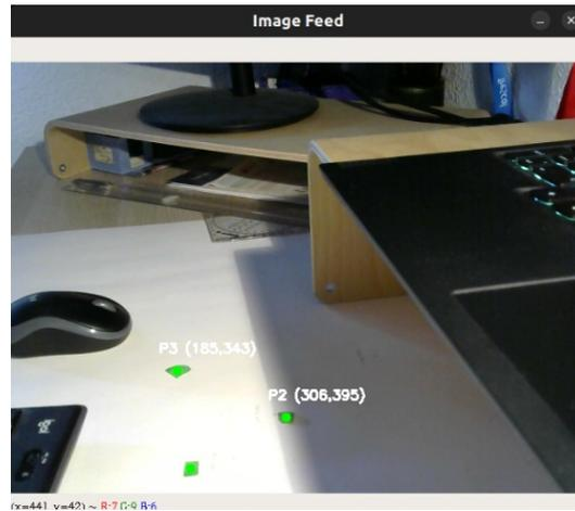
(a) Ventana donde se muestran las detecciones múltiples de manera simultánea mediante filtro de color
