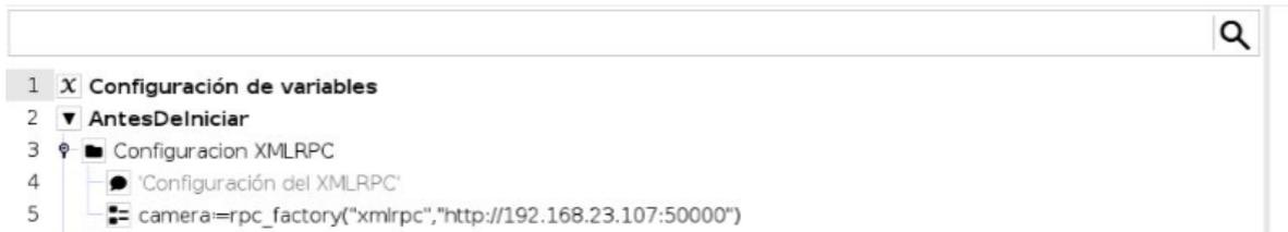
(a) Configuración de la comunicación XMLRPC en el robot
