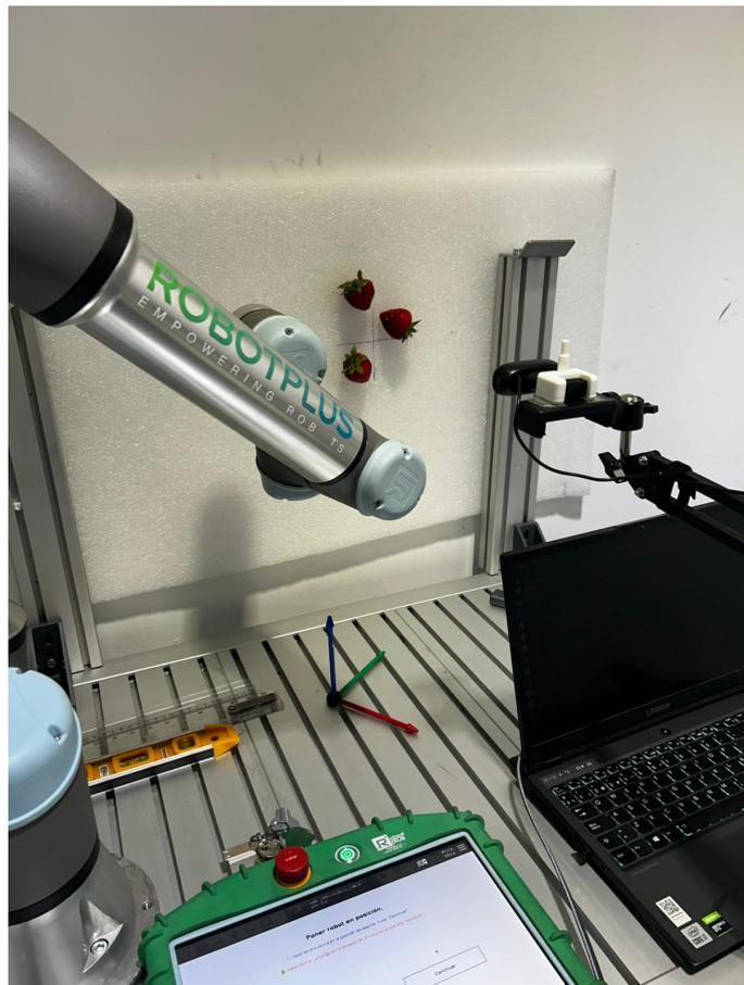
Figura 5.1: Montaje del sistema final con un UR5e
