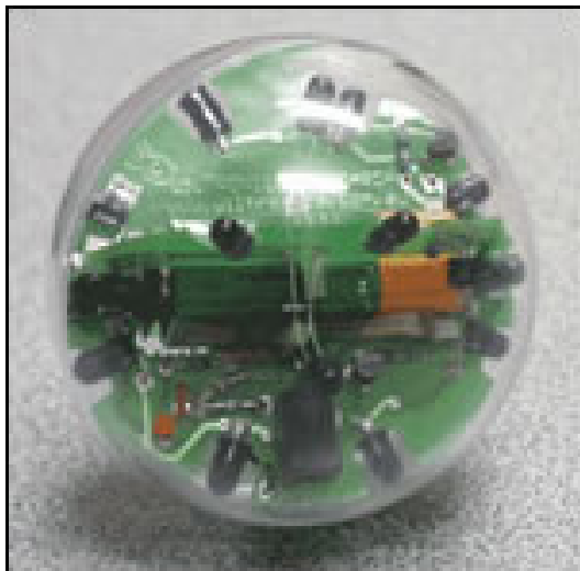
Figura 4.6: Bola emisora de infrarrojos para el futbol
