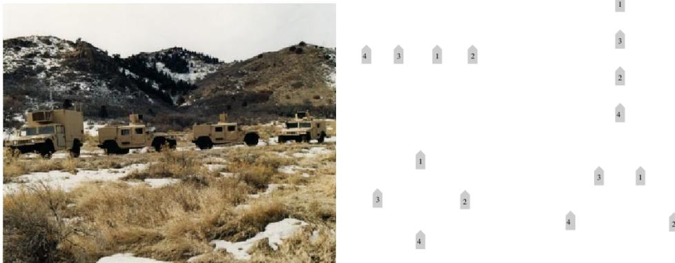
Figura 6: Equipo de cuatro camiones militares propiedad de DARPA durante el proyecto *Demo II Project* (izquierda) y formaciones en línea, columna, diamante y cuña (derecha)
