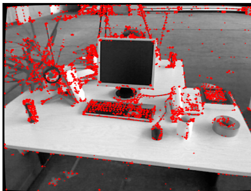
Figura 6.4: Píxeles seleccionados con FAST con umbral igual a 10 en secuencia F2D.
