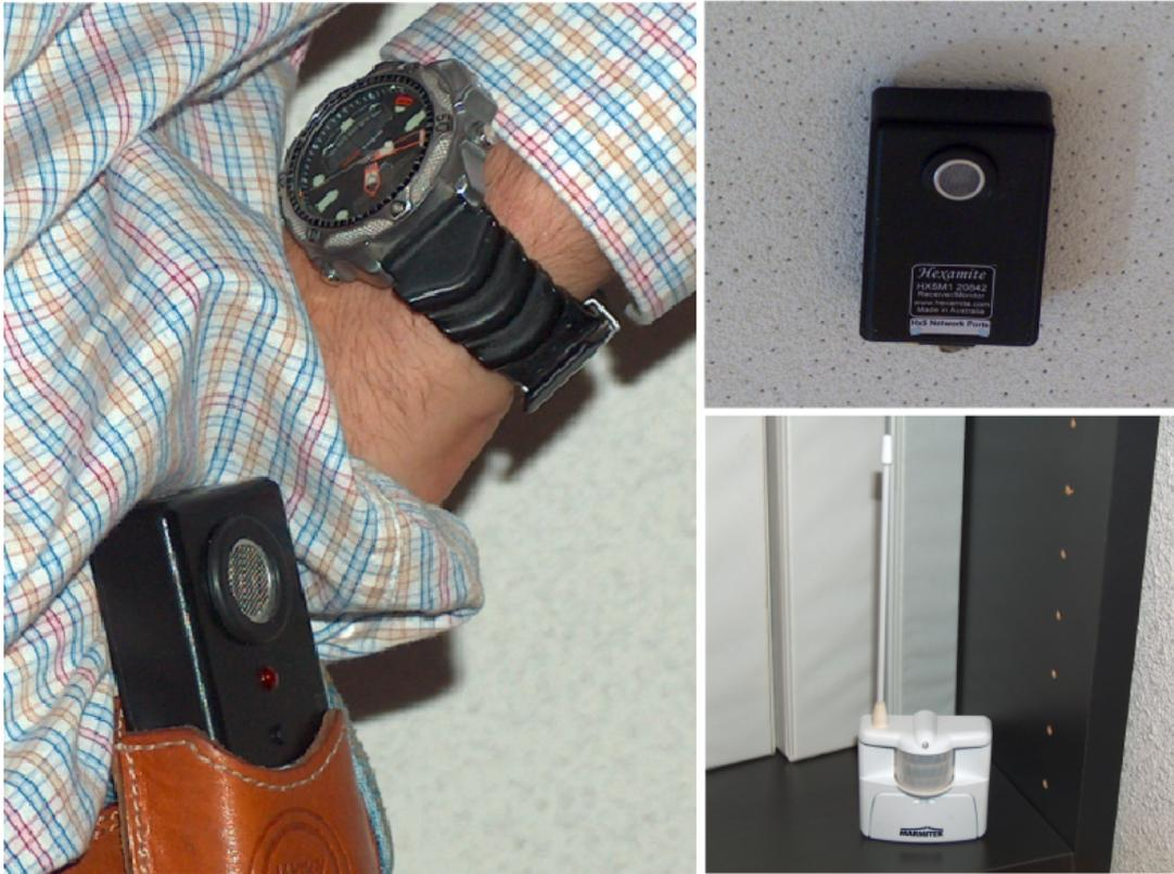
**Figura 4.7:** Sensores, receptores y balizas de la infraestructura de localización del entorno para el que se ha desarrollado NetFactotum.
