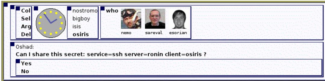
**Figura 4.6:** Captura de pantalla de Oshad pidiendo confirmación para ceder al agente SHAD de la máquina 'osiris' la contraseña de acceso al servidor SSH de la máquina 'ronin'.
