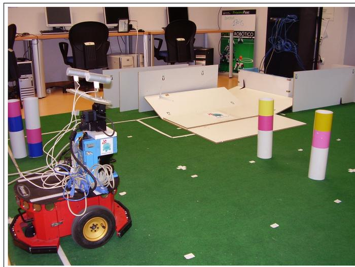
Figura 5.8: Escena real del experimento *triangulacion con dos balizas*.
