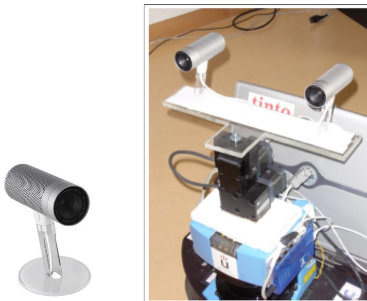
Figura 3.4: Cámara Apple iSight y configuración de las cámaras sobre el robot.
