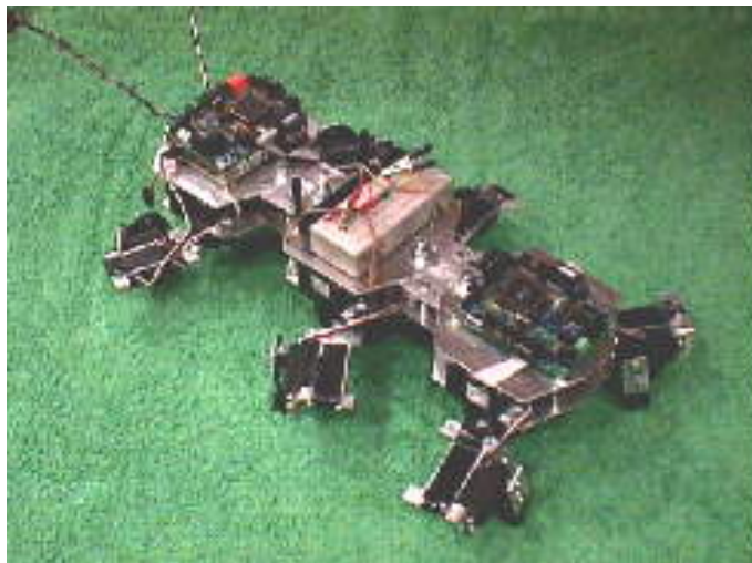
Figura1. Microbot Hexápodo controlado por dos CT6811
